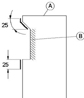
*A* – корпус обогревателя; *B* – защитная решетка отверстия для выхода воздуха
