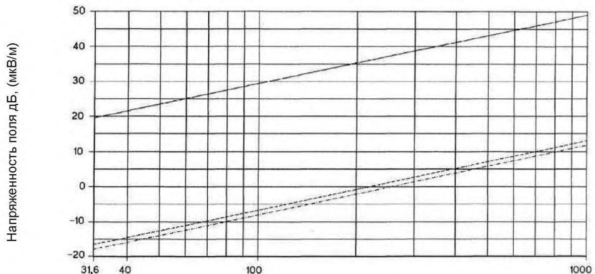
Напряженность поля полезного сигнала для минимально допустимого отношения сигнал-шум (приблизительно 60 дБ взвешенного квазипикового значения), предполагаемый коэффициент шума приемника и дипольной антенны 1/2-7 дБ; отклонение  $\pm 75$  кГц, ширина полосы 15 кГц
