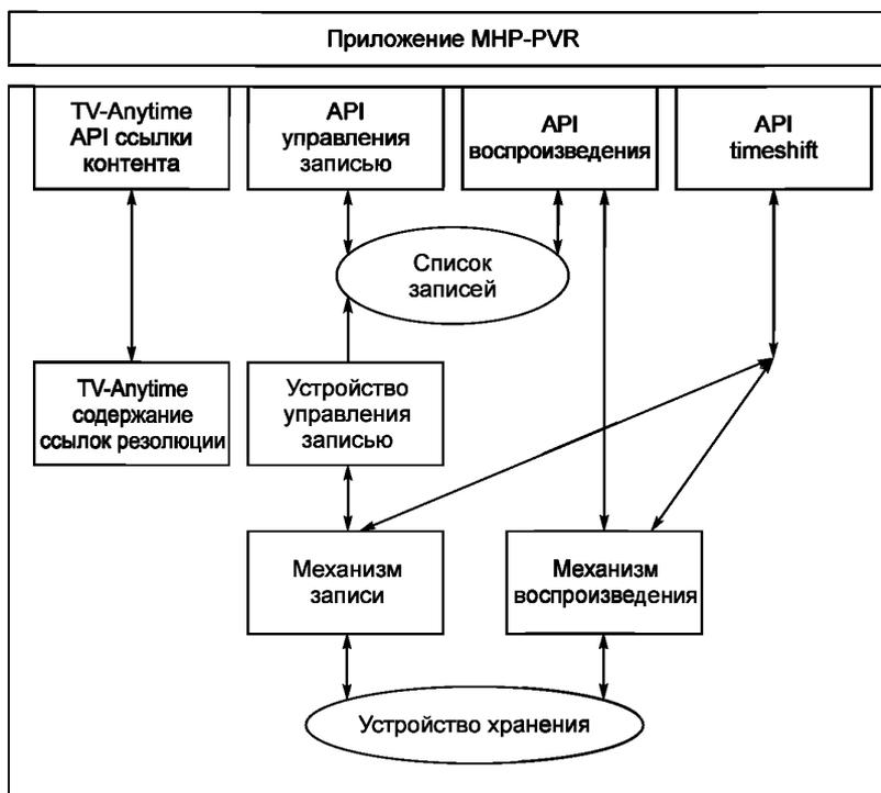
Рисунок 4 — Упрощенная архитектура MHP-PVR
