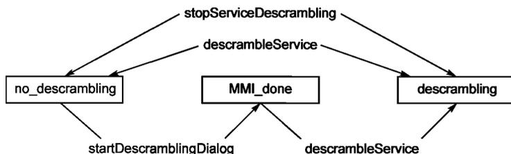
Рисунок 3 — Изменение состояния системы CA
