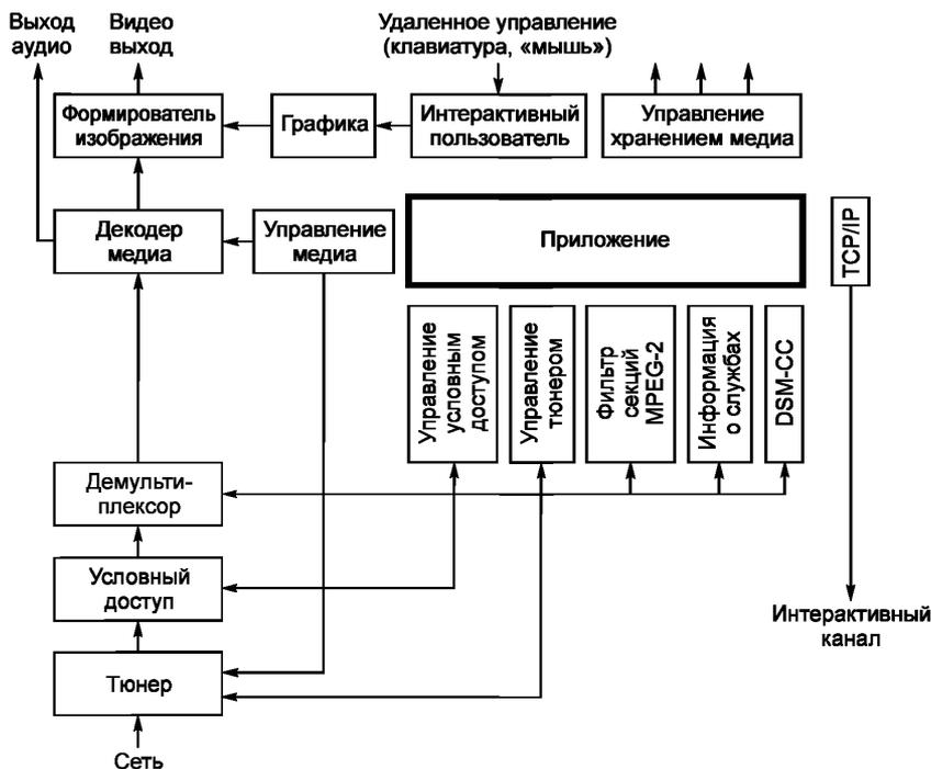
Рисунок 2 — Интерфейсы между приложениями МНР и системой МНР
