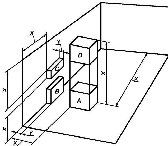
**A** — оборудование вдали от стен; **B** — оборудование, монтируемое вблизи пола или потолка и на стене или в стене; **C** — оборудование, монтируемое на стене или в стене; **D** — оборудование, подвешенное к потолку, или закрепленное на нем, или вмонтированное в потолок; **X** — минимальное расстояние от соседних поверхностей помещения, равное 1,5 м, если иначе не установлено изготовителем; **Y** — рекомендованное изготовителем минимальное выступание оборудования в помещение
