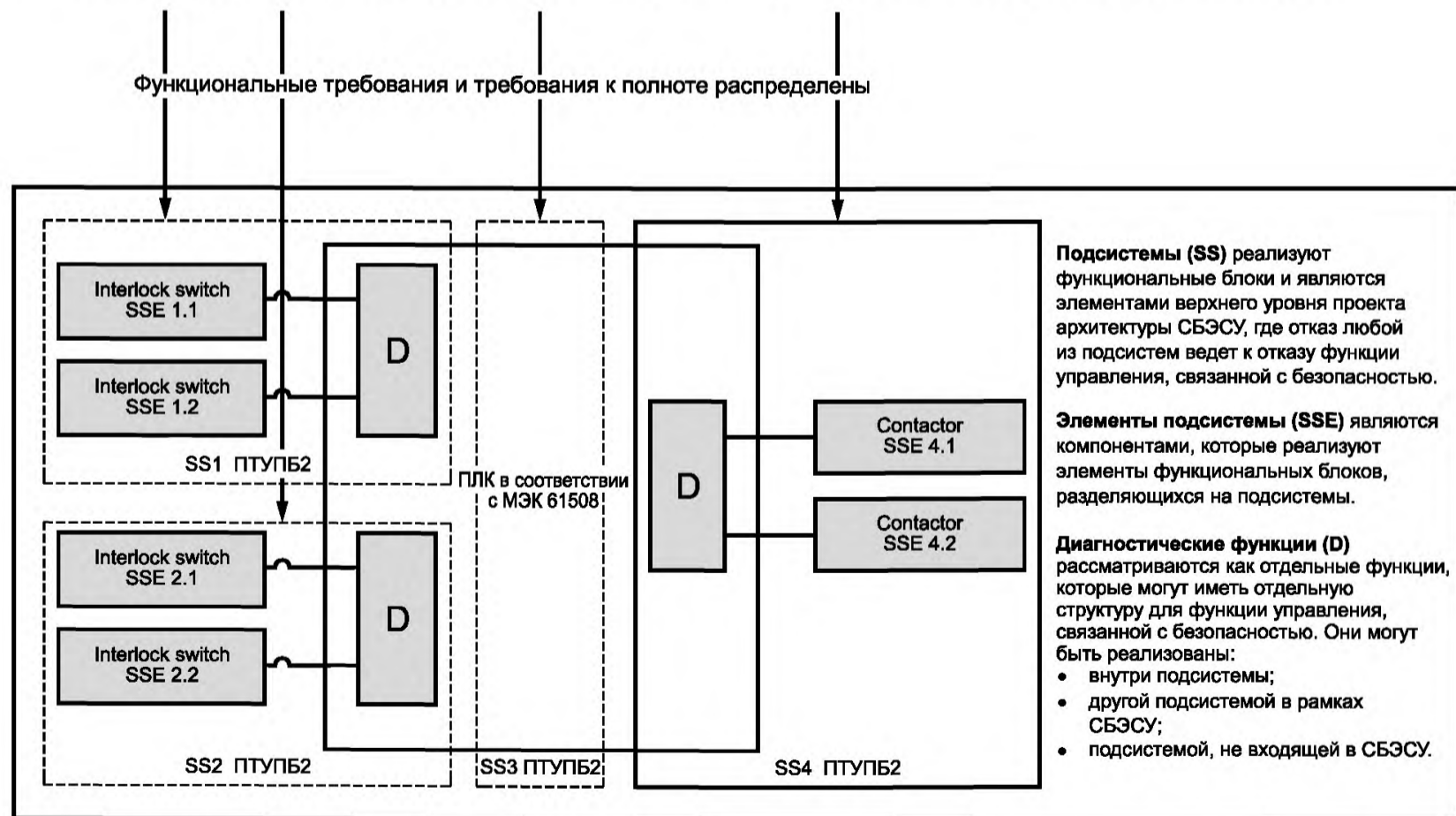
Рисунок В.7 — Архитектура СБЭСУ с диагностическими функциями, встроенными в подсистему 3
