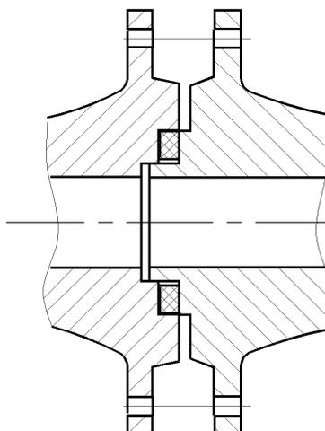
Рисунок 3.16 – Типы фланцевых соединений
