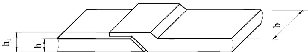
Рисунок 4.1 – Соединение концов ленты «под углом внахлестку»:
