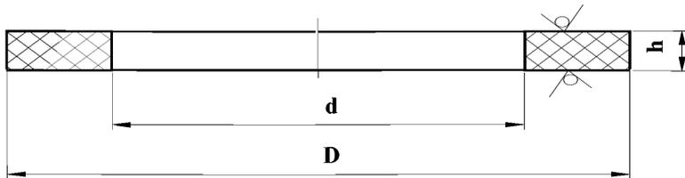
Рисунок В.1 - Конструкция прокладок из паронита.
