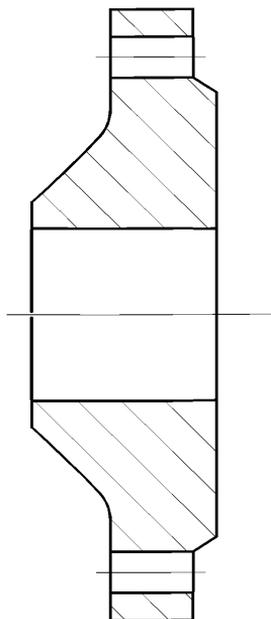
Рисунок 3.36 – Конструкции фланцев стальных приварных встык
