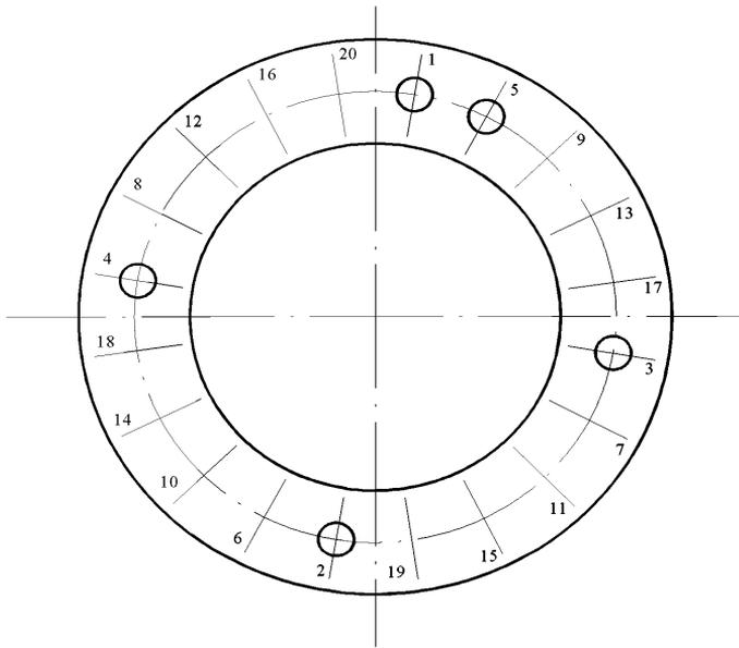
Рисунок 5.2 – Последовательность затяжки крепежа ФС
