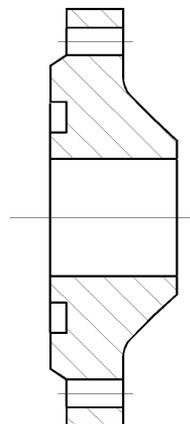
Рисунок 3.3а – Конструкции фланцев стальных приварных встык
