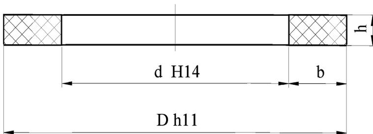
Рисунок В.2 – Конструкция прокладки из резины
