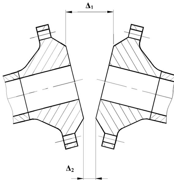
Рисунок 5.1 – Определение отклонения параллельности уплотнительных поверхностей фланцев
