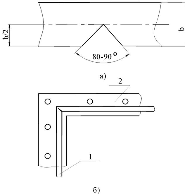
Рисунок 4.2 – Дообработка ленты в углах уплотнительной поверхности фланца:
