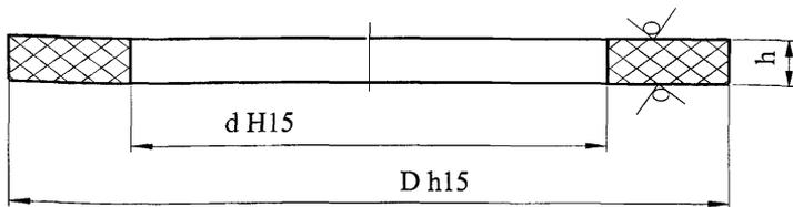
Рисунок В.1 - Конструкция прокладок из паронита и картона.
