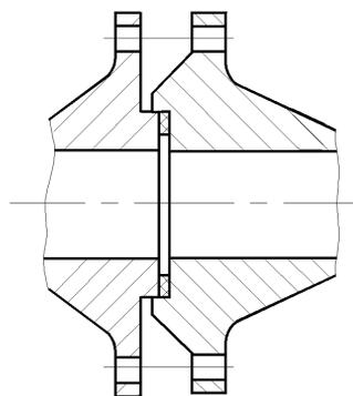
Рисунок 3.1а – Типы фланцевых соединений
