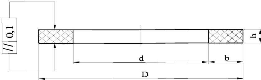
Рисунок В.3 – Конструкция прокладки из листового графита
