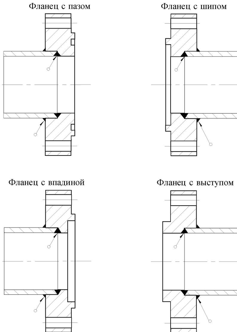
Рисунок 3.26 – Конструкции фланцев стальных плоских приварных
