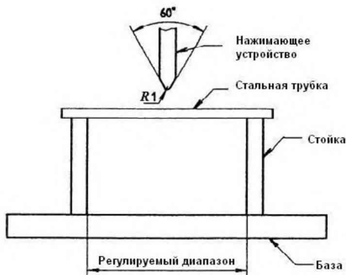
Рисунок С.1 – Оборудование для испытания на изгиб
