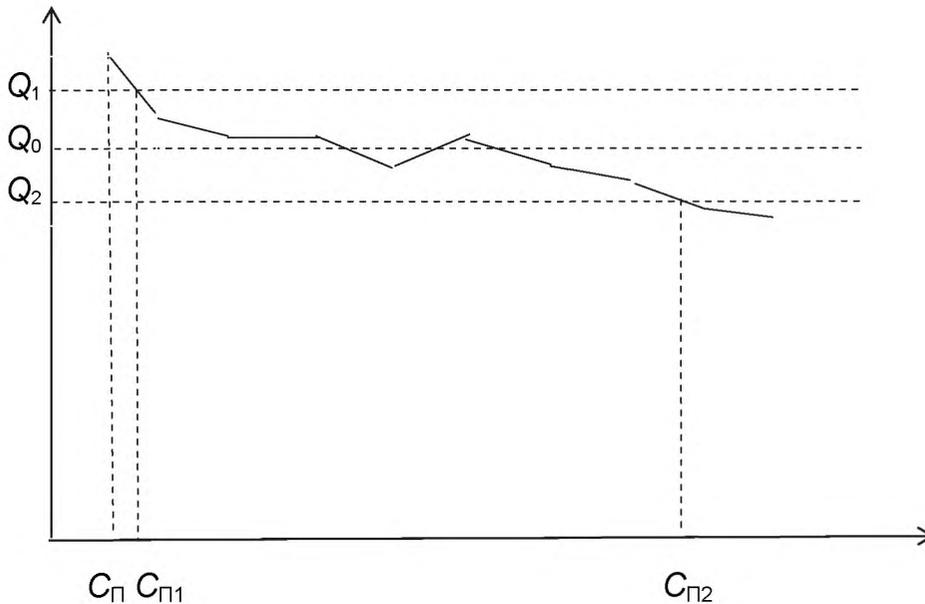
$Q_0$  — уровень линейного диапазона;  $Q_1 = 1,05Q_0$ ;  $Q_2 = 0,95Q_1$ ;  $C_{\text{п}}$  — концентрация, соответствующая пределу детектирования;  $C_{\text{п1}}$  — концентрация, соответствующая нижнему пределу линейного диапазона;  $C_{\text{п2}}$  — концентрация, соответствующая верхнему пределу линейного диапазона
