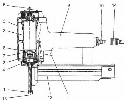
Рисунок 2 – Пример вращающейся пневматической машины (вид в разрезе)
