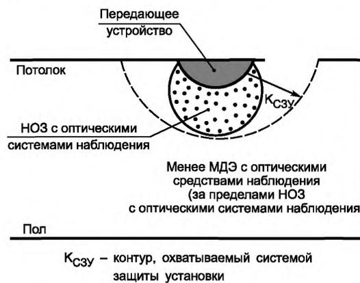
\* Пример  $K_{C3y}$  для контроля за НОЗ с оптическими системами наблюдения передающего устройства класса 1М. Если контур наблюдения нарушен, мощность излучения уменьшается до уровня менее МДЭ с оптическими средствами наблюдения. Дополнительные специальные меры должны быть приняты для наблюдения за НОЗ в случае, если она распространяется из помещения на улицу.
