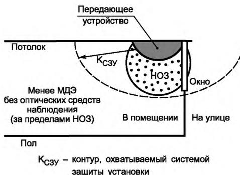
\* Пример  $K_{C3y}$  для контроля за НОЗ передающего устройства класса 3R. Мощность излучения уменьшается до уровня менее МДЭ без оптических средств наблюдения, если контур наблюдения нарушен. Дополнительные специальные меры должны быть приняты для наблюдения за НОЗ в случае, если она распространяется из помещения на улицу.
