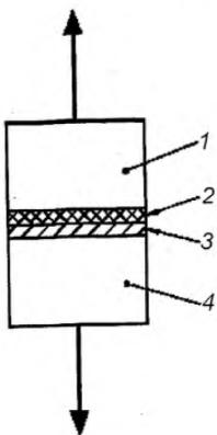
1 – окрашенная заготовка; 2 – лакокрасочное покрытие; 3 – klej; 4 – заготовка, покрытая kleem
