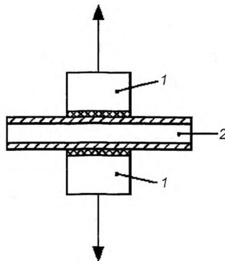
1 – заготовка, покрытая клеем; 2 – пластинка для испытаний, окрашенная с одной или обеих сторон
