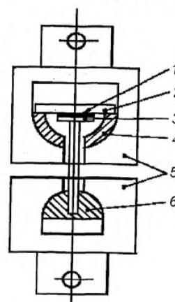
1 – лакокрасочное покрытие; 2 – окрашиваемая поверхность; 3 – заготовка; 4, 6 – шаровой подвижный патрнр; 5 – опора (сконструированная под соединение в сборе)
