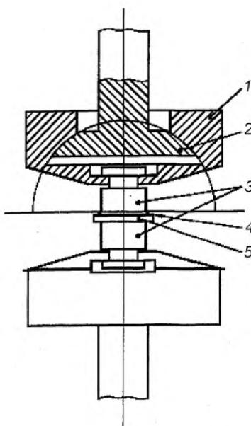
1 – опора; 2 – шаровое соединение; 3 – заготовки; 4 – лакокрасочное покрытие; 5 – окрашиваемая поверхность
