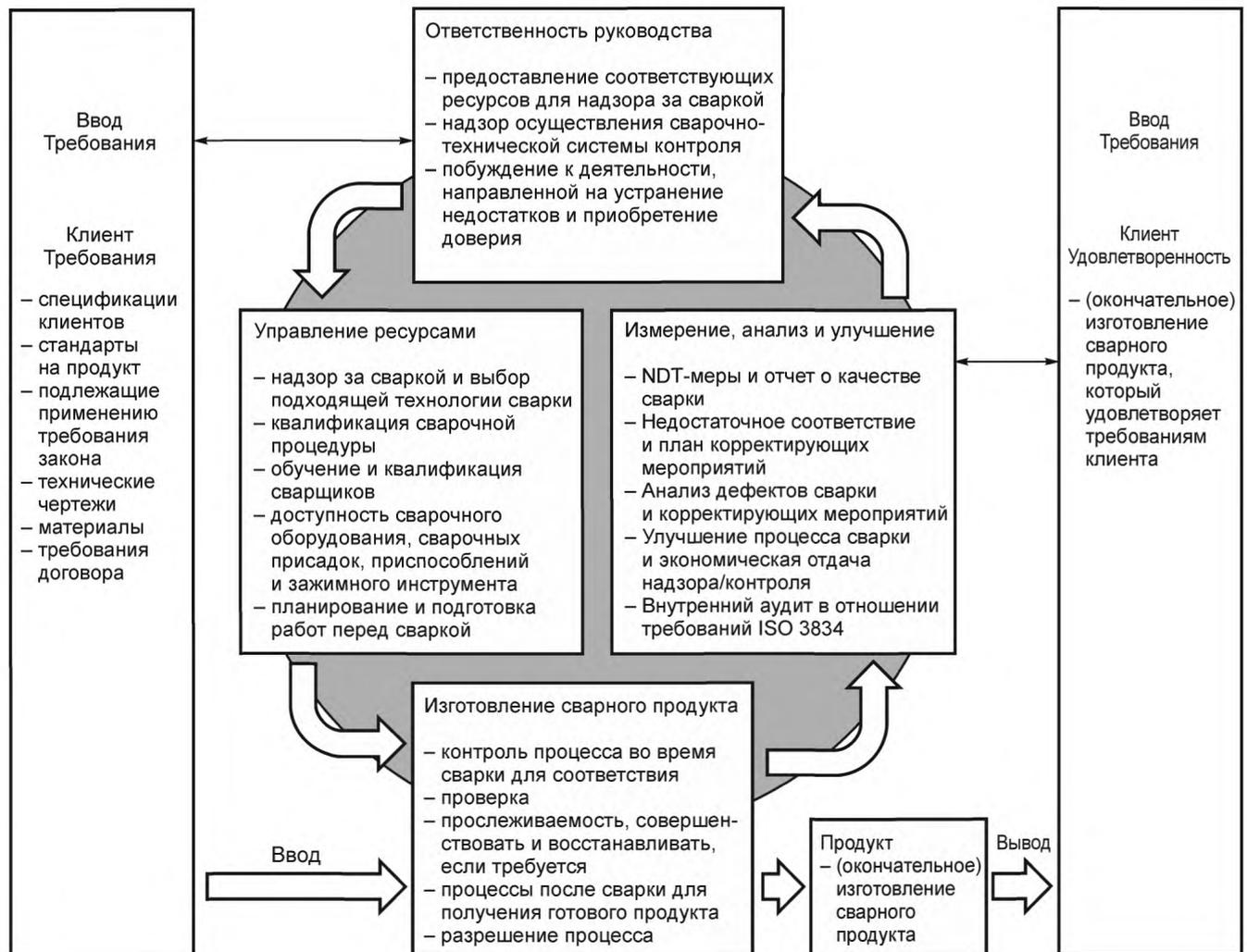
Рисунок 1 — Модель системы управления сварочным производством
