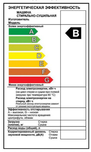
Рисунок А.1 — Вид этикетки энергетической эффективности стирально-сушильных машин
