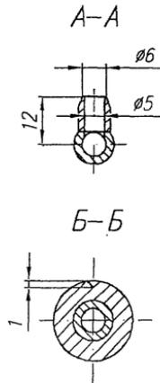
Рисунок 5- Зонд однососковый
