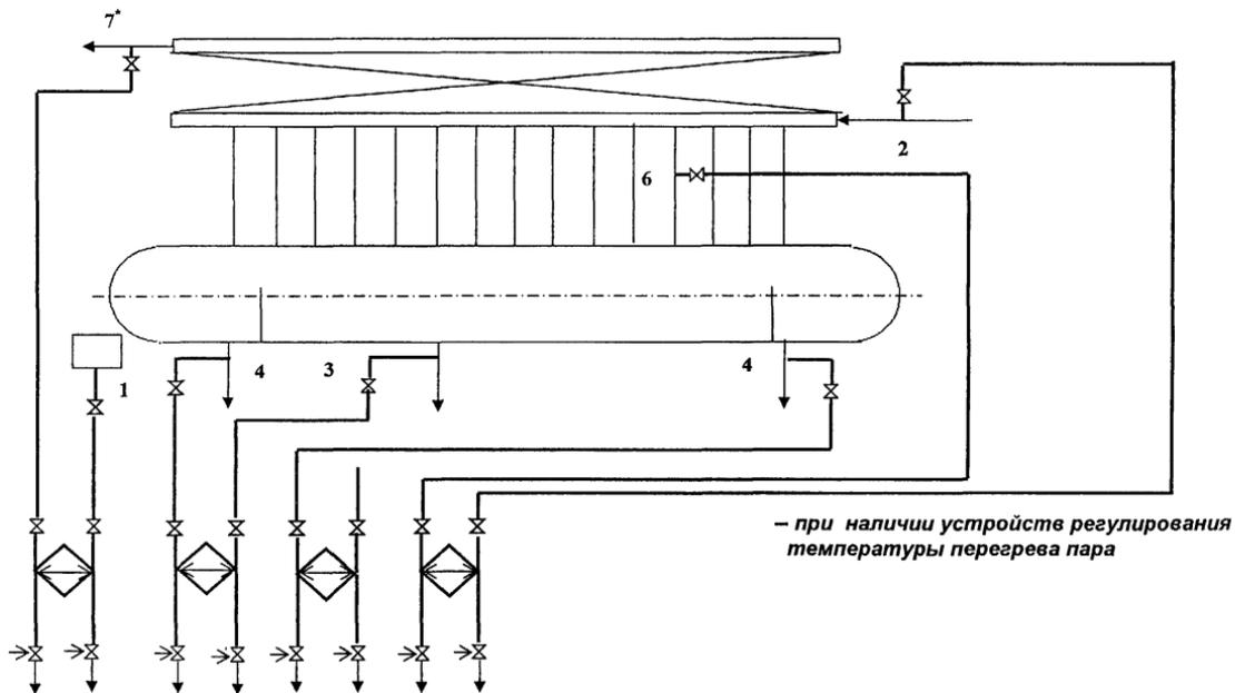
**Рисунок 17- Схема отборов проб пара и воды барабанных котлов низкого и среднего давления с двухступенчатым испарением (вторая ступень испарения- внутрибарабанная)**
