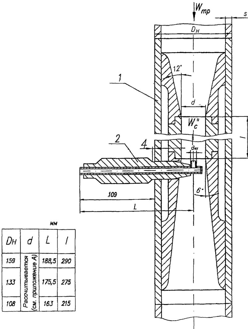
Рисунок 6- Зонд со смесителем-трубой Вентури
