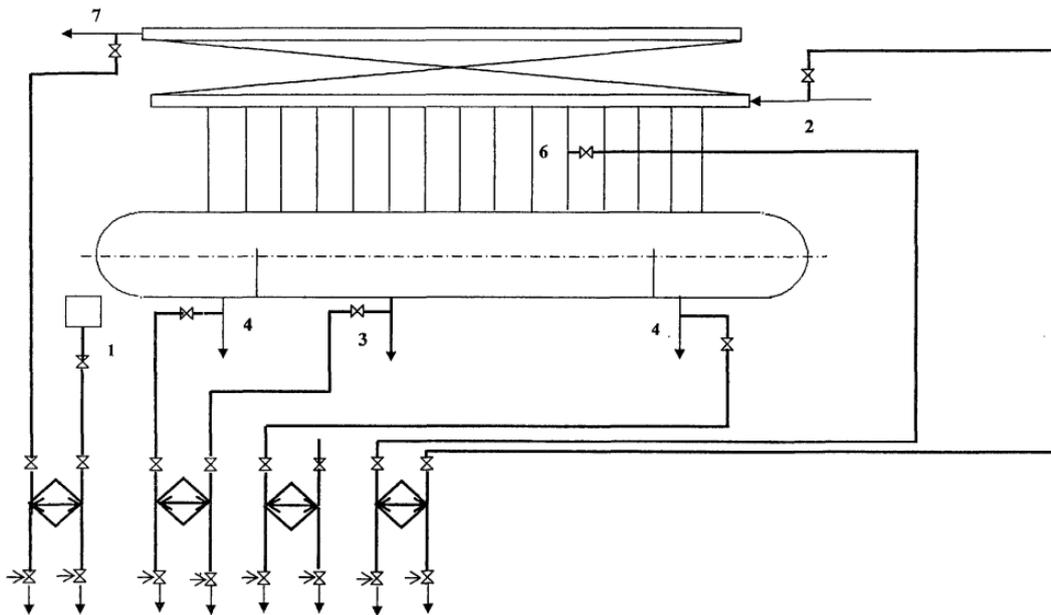
**Рисунок 11-Схема отборов проб пара и воды барабанных котлов с давлением 10 МПа (102 кгс/см<sup>2</sup>) и более с двухступенчатым испарением (вторая ступень испарения - внутрибарабанная)**
