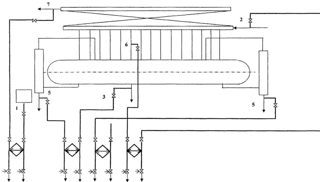
Рисунок 12- Схема отборов проб пара и воды барабанных котлов с давлением 10 МПа (102 кгс/см<sup>2</sup>) и более с двухступенчатым испарением (вторая ступень испарения - выносные циклоны)
