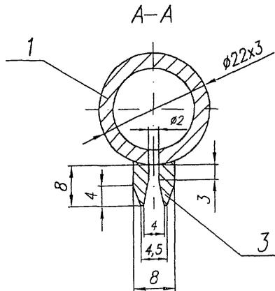
Рисунок 7- Зонд щелевой для отбора проб насыщенного пара из выносных циклонов
