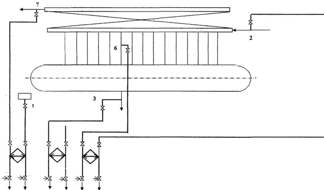
**Рисунок 10- Схема отборов проб пара и воды барабанных котлов с давлением 10 МПа (102 кгс/см<sup>2</sup>) и более с одноступенчатым испарением**
