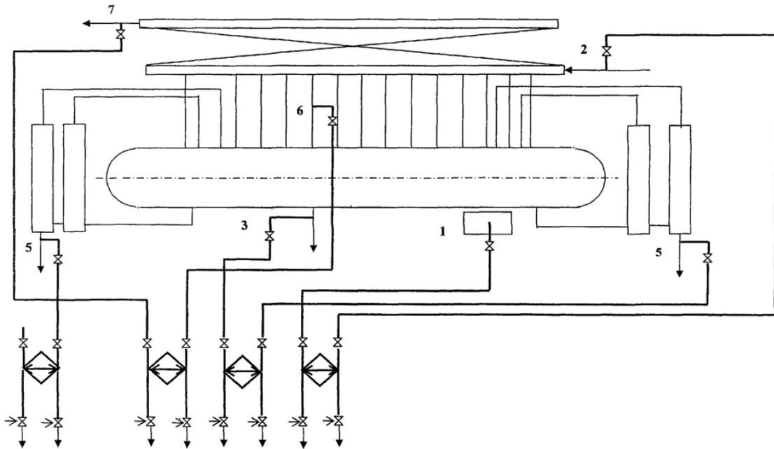
Рисунок 13- Схема отборов проб пара и воды барабанных котлов с давлением 10 МПа (102 кгс/см<sup>2</sup>) и более с трехступенчатым испарением (вторая и третья ступени испарения - выносные циклоны)
