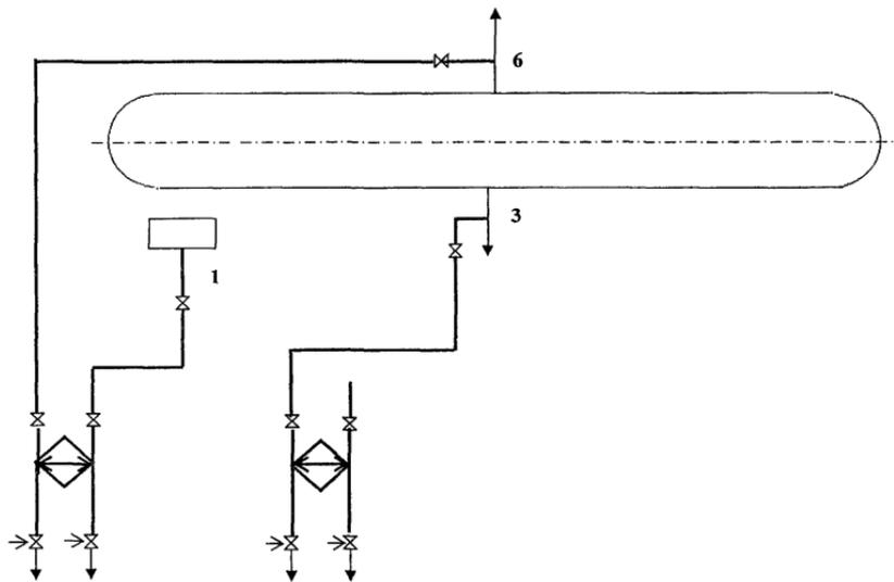
**Рисунок 15- Схема отборов проб пара и воды барабанных котлов низкого давления без пароперегревателя**
