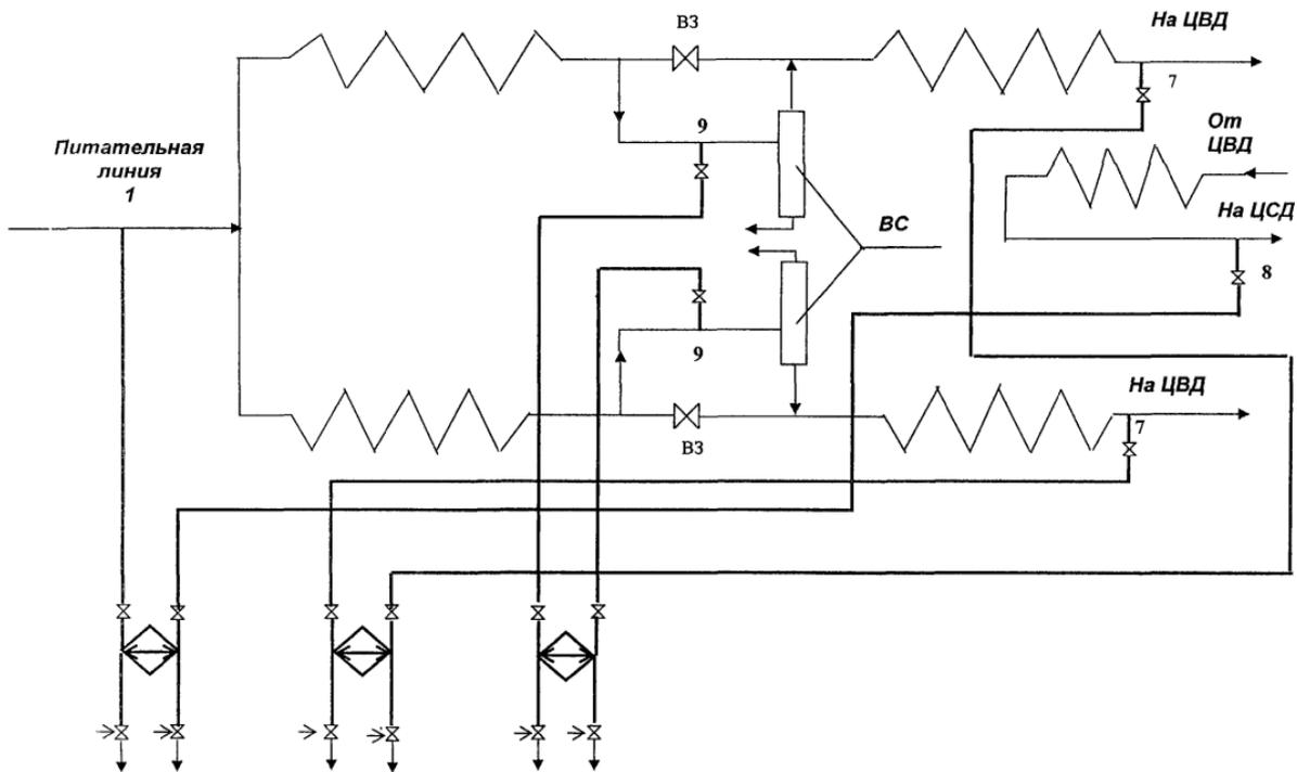
Рисунок 14- Схема отборов проб пара и воды прямоточного котла
