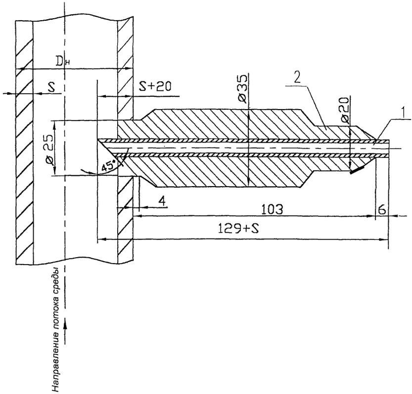
Рисунок 1—Зонд трубчатый
