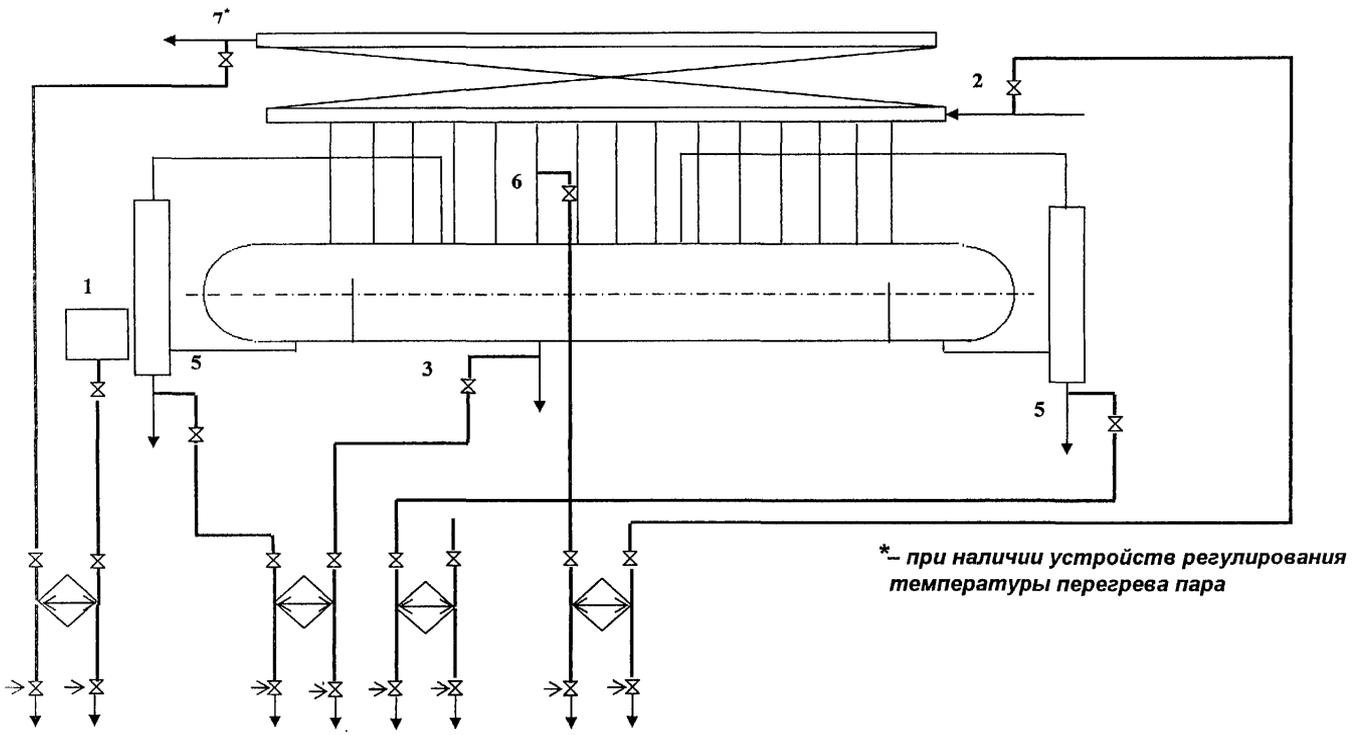
**Рисунок 19- Схема отборов проб пара и воды барабанных котлов низкого и среднего давления с трехступенчатым испарением (третья ступень испарения - выносные циклоны)**
