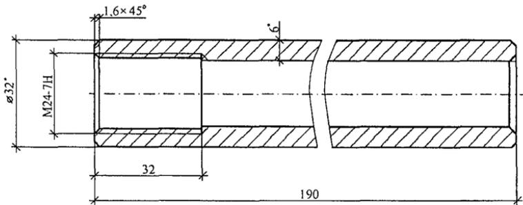
Рисунок А. 8 – Втулка концевая
