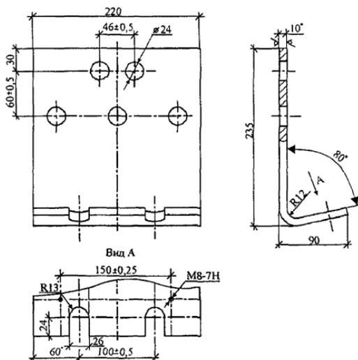
Рисунок А. 1 – Анкерная плита в сборе
