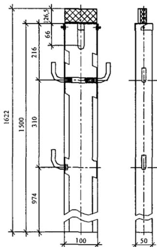
Рисунок А.4 – Стойка в сборе
