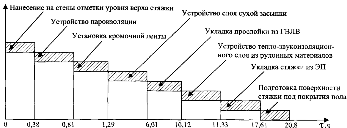
Рис. 6.8.2. График движения рабочей силы при устройстве сборного основания типа «Гамма» по выравнивающему тепло-звукоизоляционному слою сухой засыпки толщиной 60 мм с прослойкой из ГВЛБ на тепло-звукоизоляционном слое из рулонных материалов со стяжкой из элементов пола (к табл. 6.8.2)
