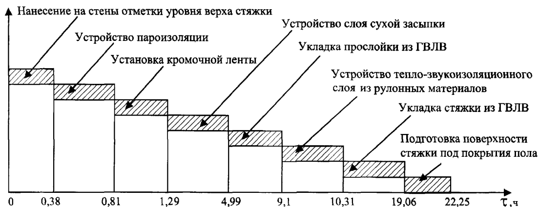
Рис. 6.7.2 а. График движения рабочей силы при устройстве сборного основания типа «Гамма» по выравнивающему тепло-звукоизоляционному слою сухой засыпки толщиной 40 мм с прослойкой из ГВЛВ на тепло-звукоизоляционном слое из рулонных материалов со стяжкой из ГВЛВ (к табл. 6.7.2)
