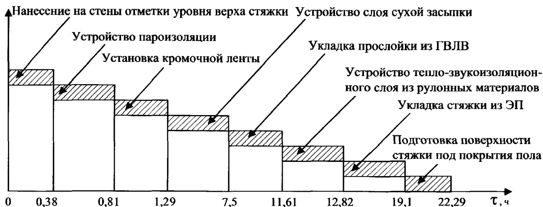
Рис. 6.10.2. График движения рабочей силы при устройстве сборного основания типа «Гамма» по выравнивающему тепло-звукоизоляционному слою сухой засыпки толщиной 100 мм с прослойкой из ГВЛВ на тепло-звукоизоляционном слое из рулонных материалов со стяжкой из элементов пола (к табл. 6.10.2)
