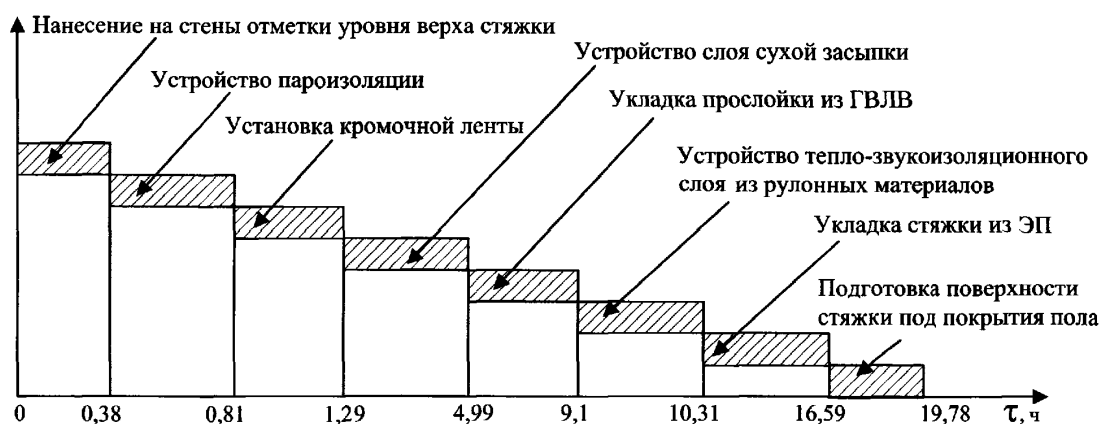
Рис. 6.7.2. График движения рабочей силы при устройстве сборного основания типа «Гамма» по выравнивающему тепло-звукоизоляционному слою сухой засыпки толщиной 40 мм с прослойкой из ГВЛВ на тепло-звукоизоляционном слое из рулонных материалов со стяжкой из элементов пола (к табл. 6.7.2)
