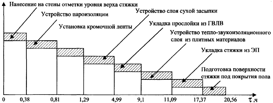
Рис. 6.7.1. График движения рабочей силы при устройстве сборного основания типа «Гамма» по выравнивающему тепло-звукоизоляционному слою сухой засыпки толщиной 40 мм с прослойкой из ГВЛВ на тепло-звукоизоляционном слое из плитных материалов со стяжкой из элементов пола (к табл. 6.7.1)
