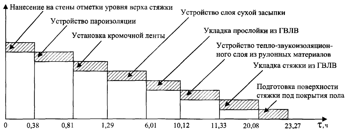
Рис. 6.8.2 а. График движения рабочей силы при устройстве сборного основания типа «Гамма» по выравнивающему тепло-звукоизоляционному слою сухой засыпки толщиной 60 мм с прослойкой из ГВЛБ на тепло-звукоизоляционном слое из рулонных материалов со стяжкой из ГВЛБ (к табл. 6.8.2)
