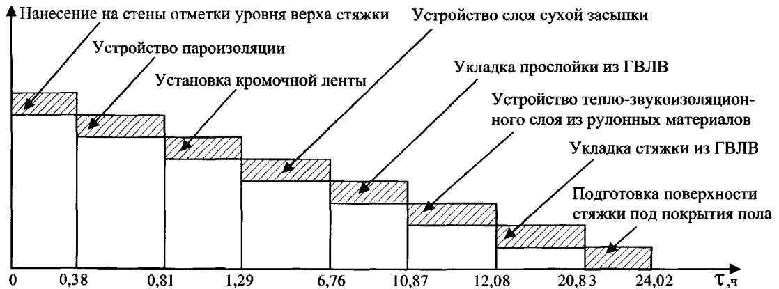
Рис. 6.9.2 а. График движения рабочей силы при устройстве сборного основания типа «Гамма» по выравнивающему тепло-звукоизоляционному слою сухой засыпки толщиной 80 мм с прослойкой из ГВЛБ на тепло-звукоизоляционном слое из рулонных материалов со стяжкой из ГВЛБ (к табл. 6.9.2)
