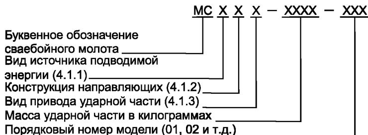
Пример словного обозначения сваебойного молота гидравлического штангового двойного действия с массой ударной части 2500 кг, третьей модели:
