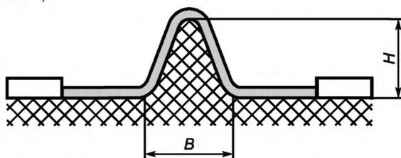
$H$  — минимальная высота ребра 2 мм;  $B$  — минимальная ширина основания, соответствующая требованиям к механической прочности
