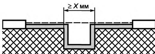
Условие: рассматриваемое расстояние утечки проходит через желобок с параллельными боковыми стенками любой глубины шириной  $X$  мм или более.
