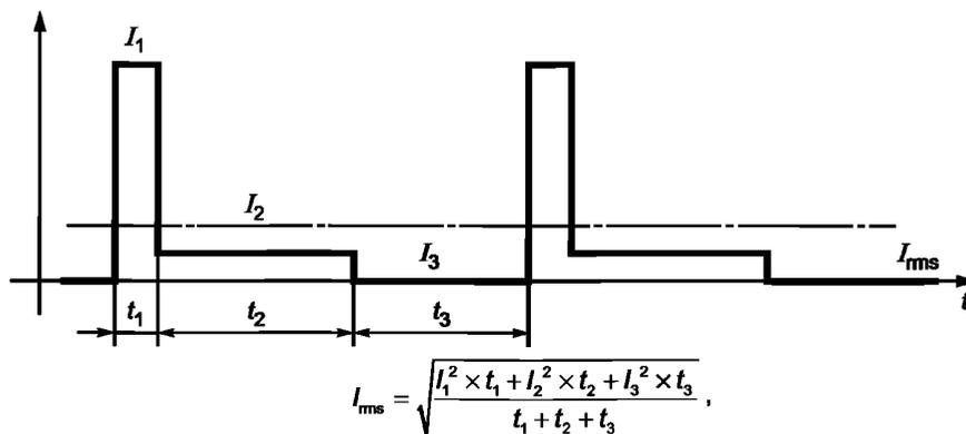
где  $t_1$  — время пуска при токе  $I_1$ ;  $t_2$  — время прохождения тока  $I_2$ ;  $t_3$  — время без тока (при  $I_3 = 0$ ).  $t_1 + t_2 + t_3$  — время цикла.
