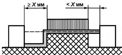
Условие: в рассматриваемое расстояние утечки входит нескрепленный стык с желобком шириной менее  $X$  мм с одной стороны или  $X$  мм и более с другой стороны.
