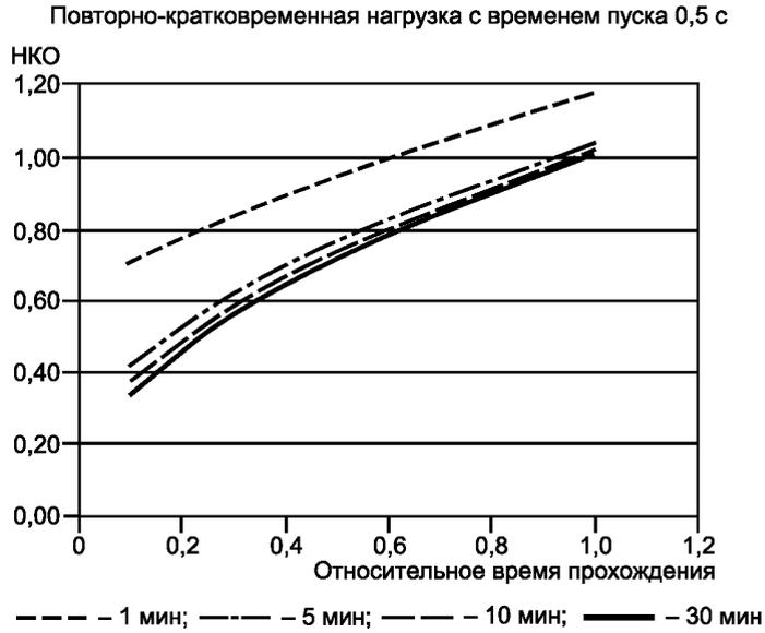
Рисунок Е.7 — Графический пример соотношения между эквивалентным НКО и параметрами при повторно-кратковременном режиме  $t_1 = 0,5$  с,  $l_1 = 7 \times l_2$  для разного времени цикла.
