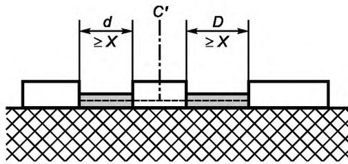
Размер воздушного зазора равен  $d+D$ ; Расстояние утечки равно  $d+D$ ;  $C'$  — свободно движущаяся часть.
