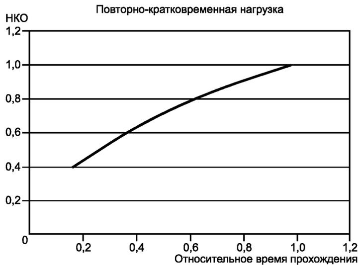
Рисунок Е.8 — Графический пример соотношения между эквивалентным НКО и параметрами при повторно-кратковременном режиме  $l_1 = l_2$  (без пускового сверхтока)
