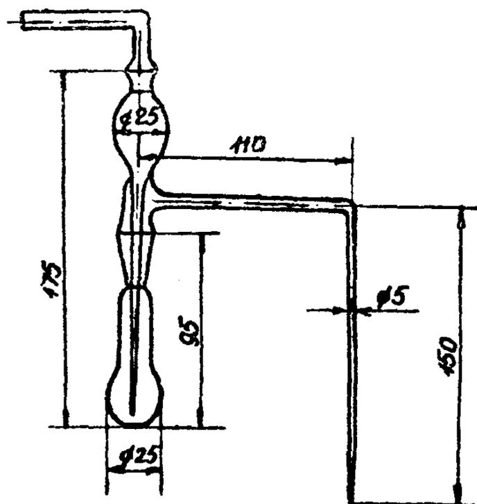
Рис. I Прибор для сжигания хлорорганических
