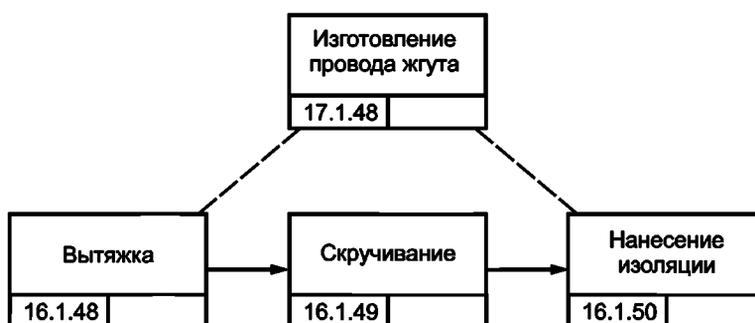
Рисунок В.5 — Процесс изготовления провода жгута [5]
