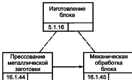
Рисунок В.3 — Процесс изготовления блока изделия GT-350 [5]
