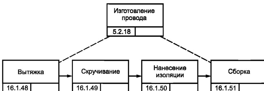
Рисунок В.6 — Процесс изготовления проводов изделия GT-350 [5]
