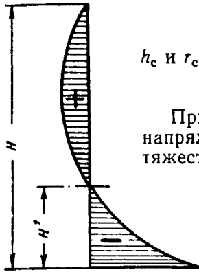
Рис. 6. Эпюра изгибающего момента для сжатого элемента, нагруженного поперечной нагрузкой
