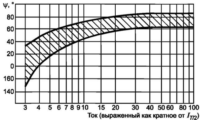
Рисунок 1 — Момент включения тока при испытании № 1
