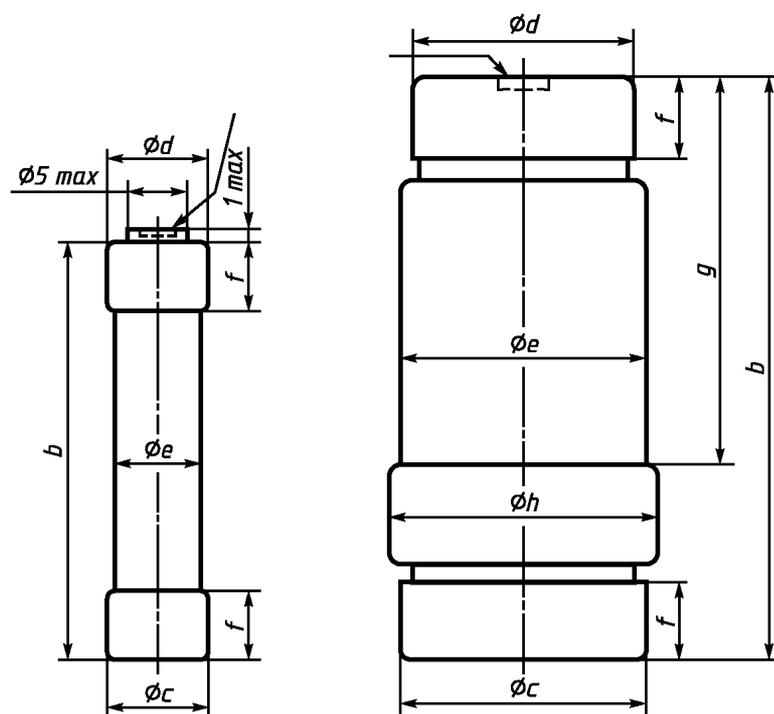
Токоведущие части выполнены из меди или ее сплавов, изоляционные части — из материала с достаточной теплостойкостью
