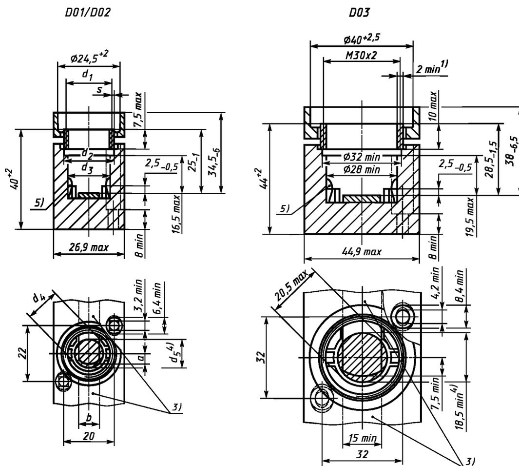
Рисунок 2 — Основные размеры оснований предохранителей типа D, лист 1
