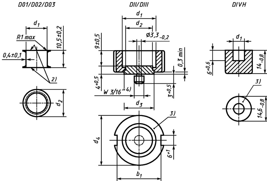
Изоляционные части выполнены из керамики, контактные части — из меди или ее сплавов.
