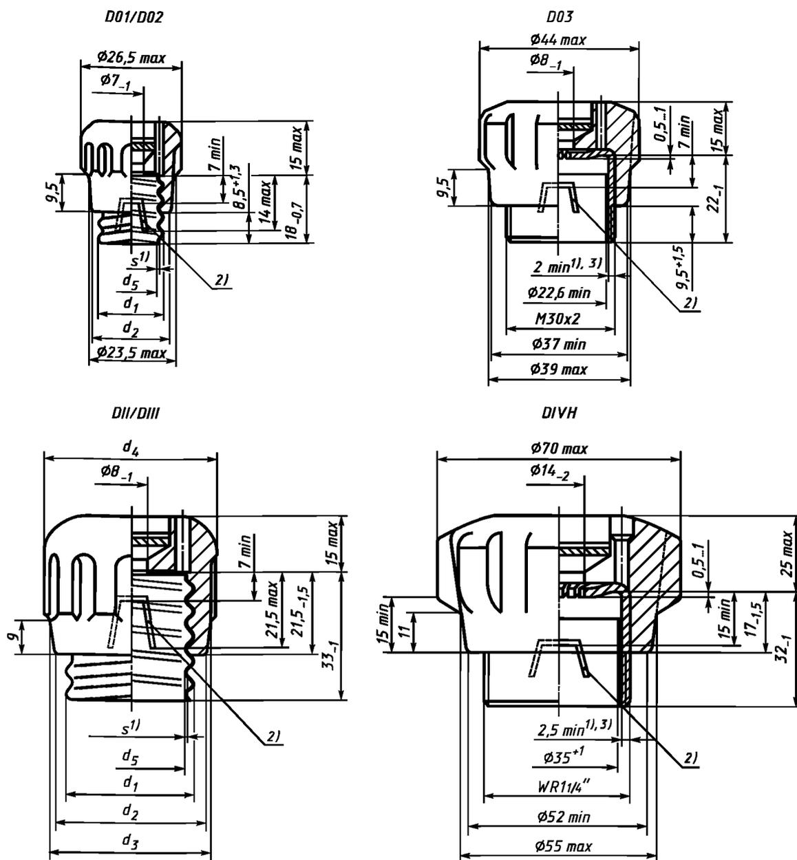
Изоляционные части выполнены из керамики, резьбовая гильза — из меди или ее сплавов.
