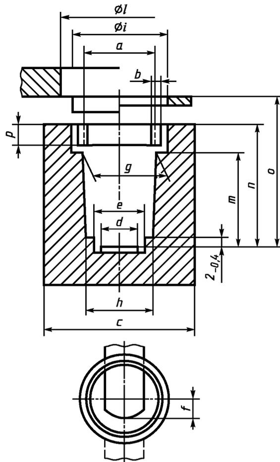
Токоведущие части выполнены из меди или ее сплавов, изоляционные части — из материала с достаточной теплостойкостью.
