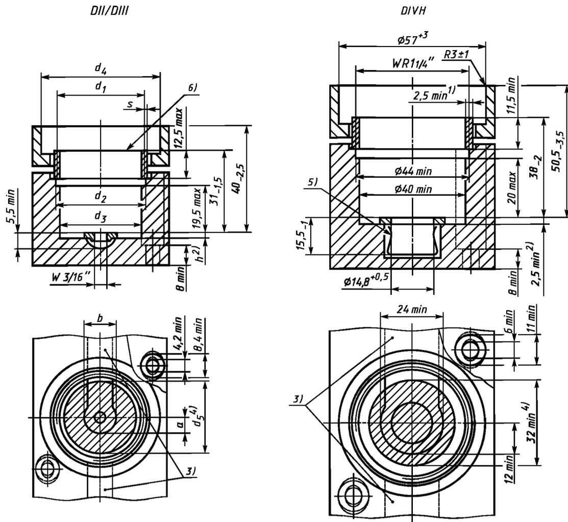
Изоляционные части выполнены из керамики, резьбовая гильза — из меди или ее сплавов.
