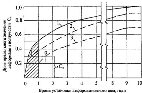
1 – ползучесть бетона изготовленной балки; 2 – ползучесть после нагружения балок бетоном швов омоноличивания и выравнивающего слоя; 3 – ползучесть после нагружения балки всей постоянной нагрузкой от элементов мостового полотна (заштрихованная часть принята по СНиП 2.05.03–84\* (СП 35.13330.2011))
