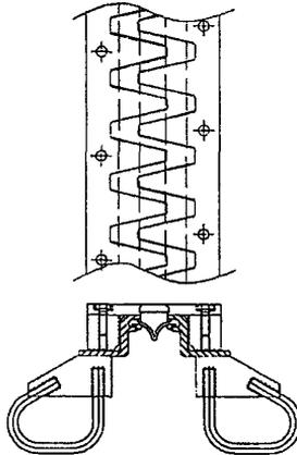
Рисунок 9 – Конструкция однопрофильного ДШ с дополнительными элементами перекрытия
