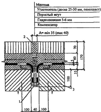
1 – компенсатор; 2 – шов; 3 – пролетное строение
