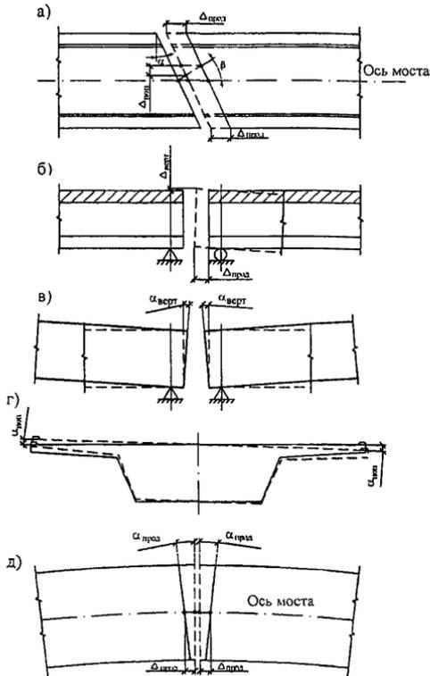
а – линейные горизонтальные продольные и поперечные перемещения сопрягаемых концов пролетных строений, равномерные по длине шва;
