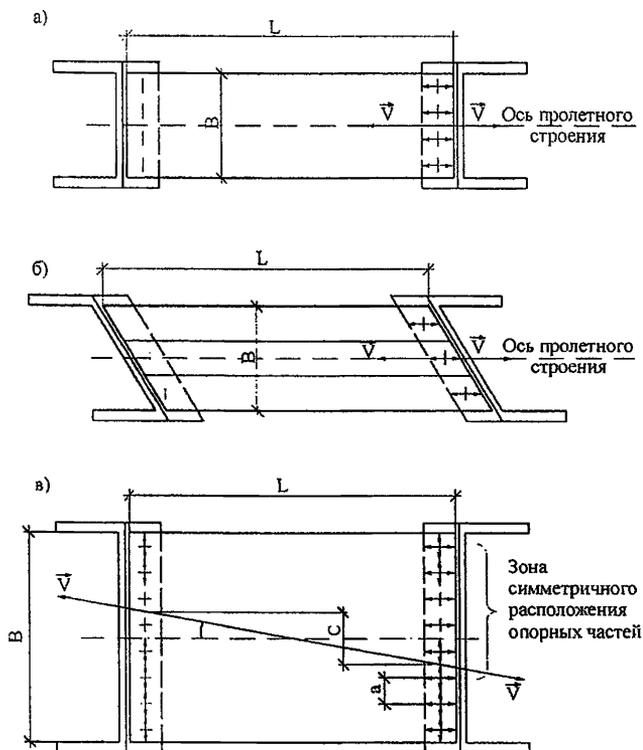
а – при  $L/B \geq 2$  в прямых пролетных строениях; б – при  $L/B \geq 2$  в косых пролетных строениях; в – при  $L/B < 2$  в прямых пролетных строениях
