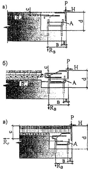
а – при анкеровке КДШ в недобетонированной плите пролетного строения; б – при анкеровке в бетонном приливе, устроенном до уровня верха покрытия; в – при анкеровке в бетонном приливе, устроенном ниже покрытия
