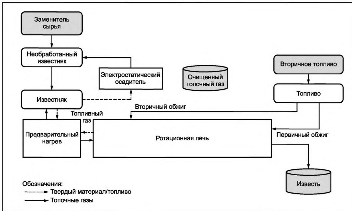
Рисунок А.3 — Путь тяжелых металлов в известьобжигательной печи с предварительным нагреванием (сухой процесс)
