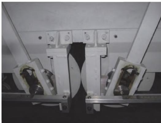
Рисунок 4 – Принцип работы аппарата для определения степени сводообразования сыпучего материала
