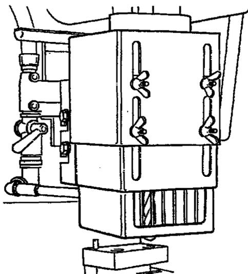
Рисунок А.6 (b) — Неподвижное регулируемое ограждение
