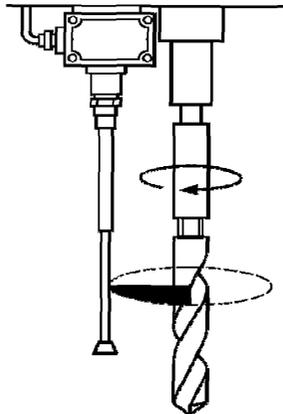
Рисунок А.7 — Телескопическое устройство для защиты сверла
