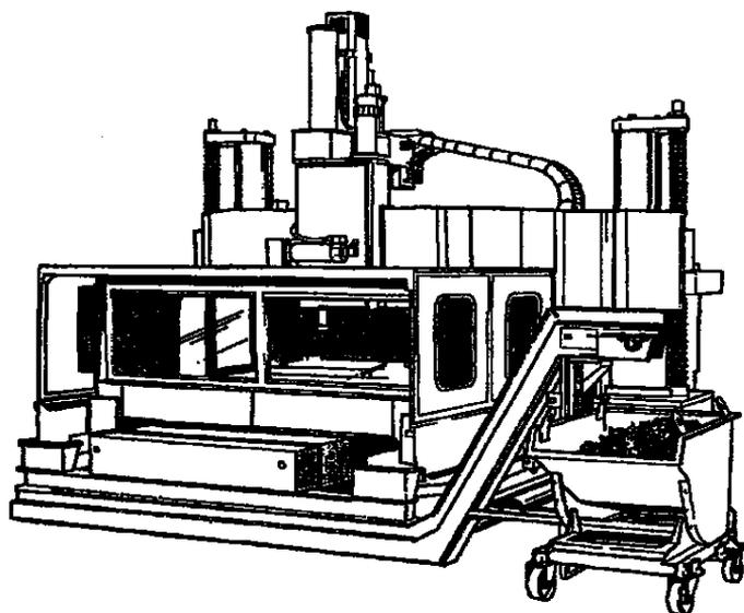
Рисунок А.3 — Вертикально-сверлильный станок с координатным столом
