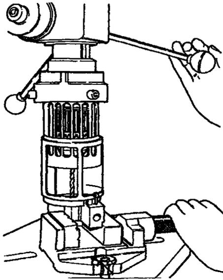
Рисунок А.6 (с) — Неподвижное регулируемое ограждение
