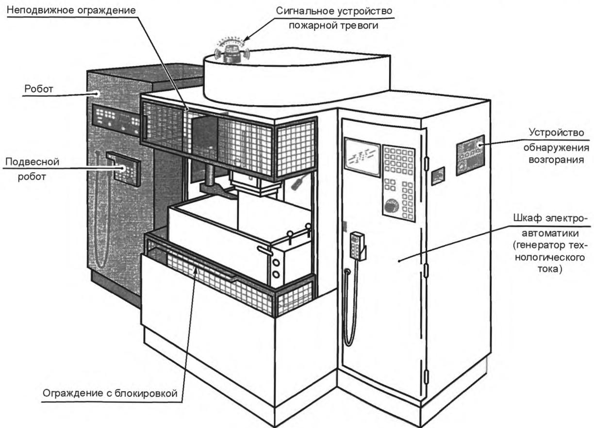
Рисунок А.8 — Электроэрозионный копировально-прошивочный станок с роботом
