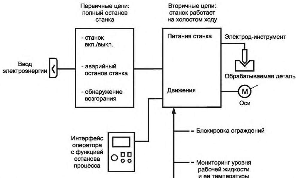
Примечание — Открытие ограждения или сбой установленных значений температуры или уровня технологической жидкости должно привести к выключению электроэрозионного процесса, к остановке движения детали станка, отключению энергоснабжения и переводу станка в режим холостого хода, с указанием ошибок.
