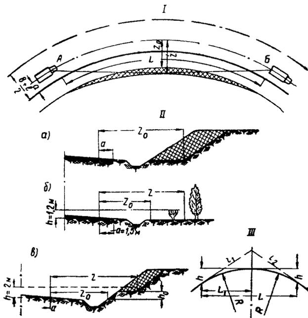
Рис. 4. Расчет видимости на кривых
