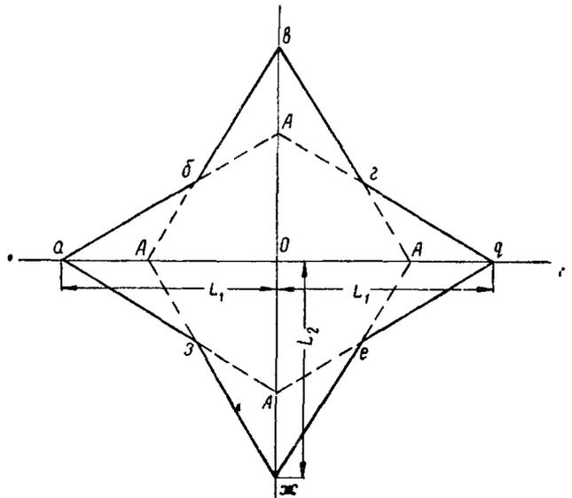
Рис. 6. Схема обеспечения боковой видимости на пересечениях и примыканиях
