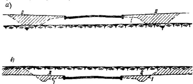
Рис. 1. Очередность строительства внутренних автомобильных дорог до постройки ливневой канализации
