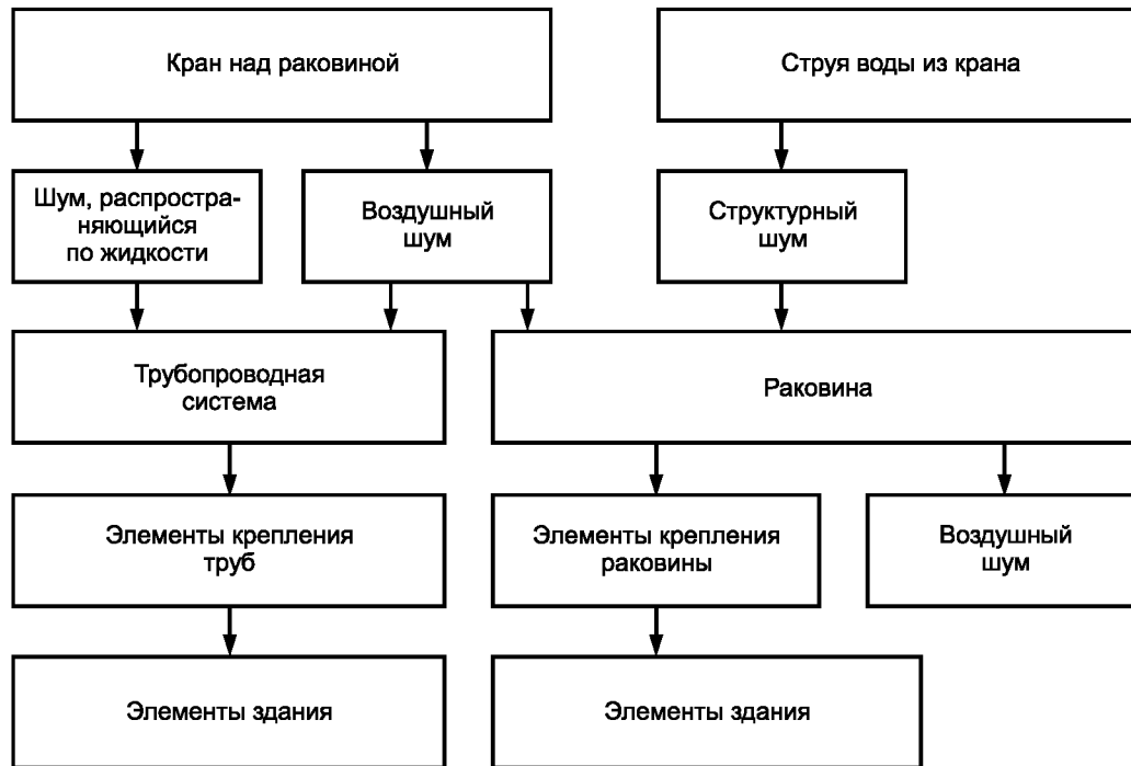
Рисунок 5 — Пути звукопередачи от крана над раковиной
