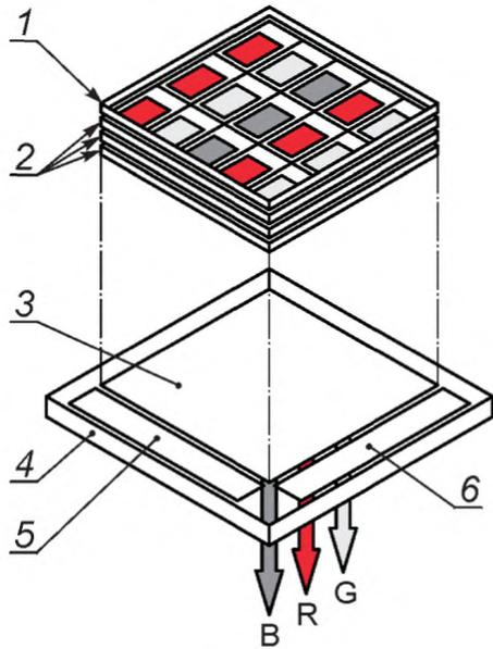
1 — катод; 2 — органический слой (электронно-транспортный слой, излучающий слой, дырочно-транспортный слой); 3 — анод; 4 — низкотемпературная поликремниевая TFT-подложка; 5 — управляющая шина (горизонтальная); 6 — управляющая шина (вертикальная)
