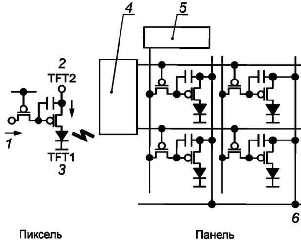
1 — сигнал; 2 — ток; 3 — излучение света; 4 — устройство развертки изображения; 5 — устройство передачи данных; 6 — источник питания
