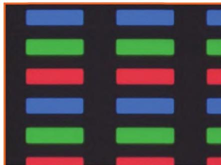
Рисунок 7 — Электролюминесцентное изображение пикселей в панели дисплея
