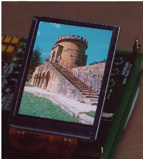
Рисунок 6 — OLED дисплей с 3,5-дюймовой QVGA-панелью
