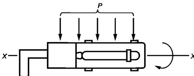
Наибольшая площадь проекции светильника в данном примере — это вид сбоку. Светильник поворачивают вокруг оси  $x-x$  на  $180^\circ$  в течение 10 мин.
