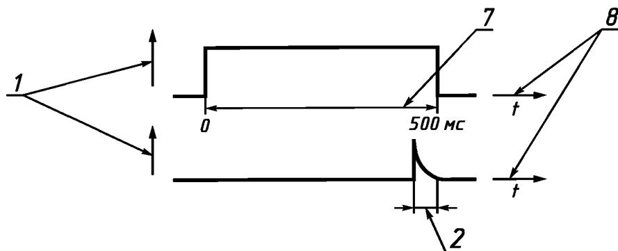
1 — входной ток; 2 — время срабатывания реле; 3 — блок питания *PSU2*; 4 — блок питания *PSU1*; 5 — испытуемый инвертор; 6 — регистратор длительности импульса; 7 — длительность импульса тока на входе тиристора; 8 — сигналы на входе тиристоров *TH1* и *TH2* соответственно
