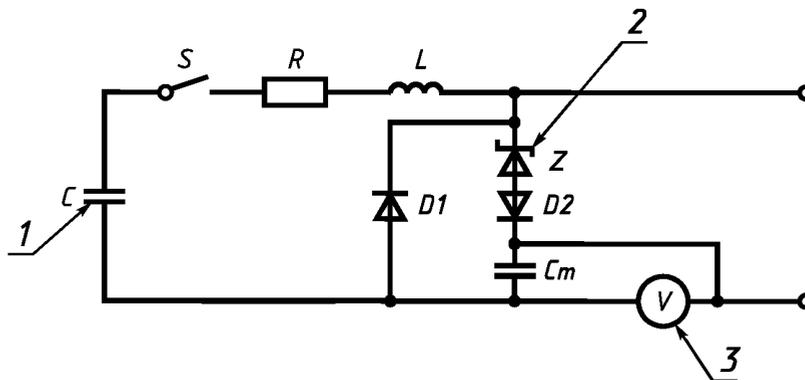
1 — конденсатор для генерации импульсов, заряженный до  $V_{pk}$ ; 2 — диод Зенера с напряжением  $V_{z1}$ ; 3 — высокоомный вольтметр
