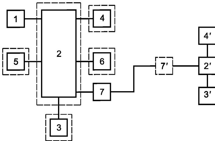
1 — извещатель; 2, 2' — установка управления; 2 — охранный (охранно-пожарный) приемно-контрольный прибор, 2' — пульт централизованного наблюдения; 3, 3' — источник электропитания; 4, 4' — световой и/или звуковой оповещатель; 5 — устройство, управляемое установкой управления; 6 — программируемое входное устройство; 7 — шифрующее устройство; 7, 7' — сигнальный интерфейс, modem; 7, 7' — система передачи извещений
