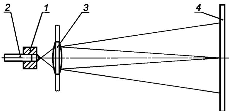
1 — средство проверки; 2 — лазерный пучок; 3 — проектор; 4 — экран
