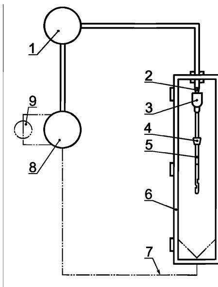
1 – гидравлическим генератор давления и система контроля; 2 – соединитель; 3 – запирающее устройство; 4 – зажим или кран; 5 – испытуемый катетер; 6 – пример испытательной камеры; 7 – возврат использованной жидкости (дополнительный); 8 – резервуар для жидкости, создающей давление; 9 – фильтрующая система (дополнительная)
