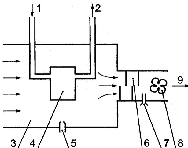
1 — вход газового потока; 2 — отсасываемый поток; 3 — испытательное ограждение;
