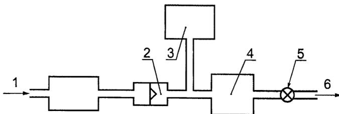
1 — вход СВГС; 2 — присоединенное устройство (тип 1 — для малорасходных систем; тип 1Н — для высокорасходных систем); 3 — устройство измерения давления; 4 — устройство измерения потока; 5 — устройство регулирования потока; 6 — всасывающий поток
