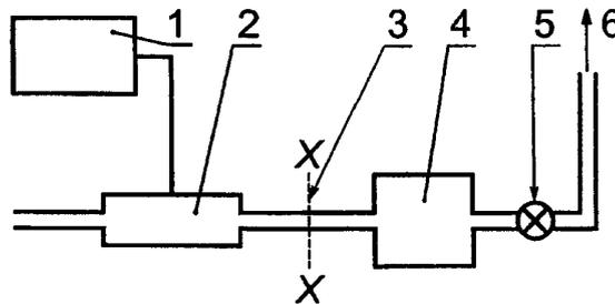
1 — регистрирующий прибор; 2 — устройство измерения потока; 3 — вход в СВГС; 4 — передающие и принимающие системы СВГС; 5 — устройство регулирования потока;
