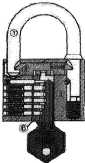
*Условные обозначения: 1 — дужка, 2 — упор, 3 — корпус, 4 — пружина дужки, 5 — ключ, 6 — цилиндрический механизм секретности*
