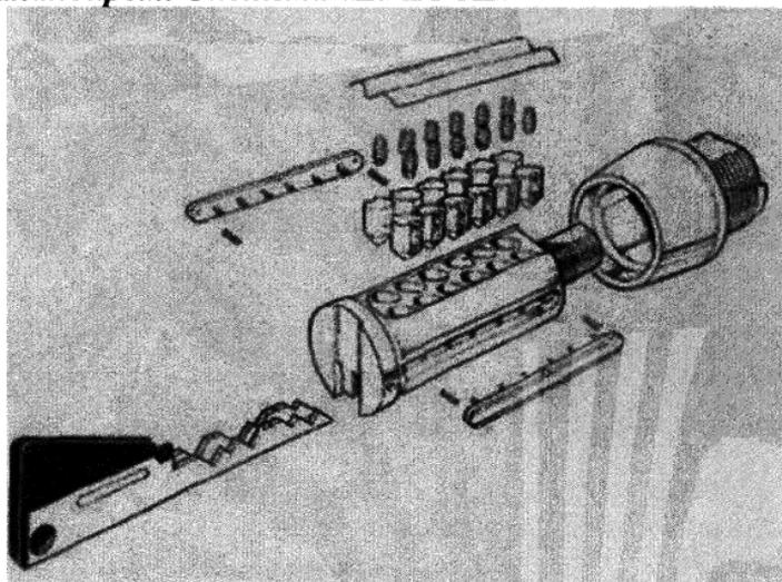
Ключ имеет две бородки, расположенные с одной стороны ключа. Цилиндровый механизм
