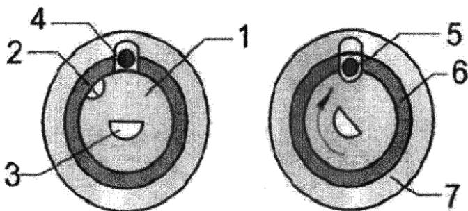
*Условные обозначения: 1 — кодовый диск (шайба), 2 — паз на кодовом диске, 3 — скважина для ключа, 4 — обычно подпружиненный запирающий элемент в положении «закрыто», 5 — запирающий элемент в положении «открыто», 6 — внутренний цилиндр, соединенный с поводком, 7 — корпус.*
