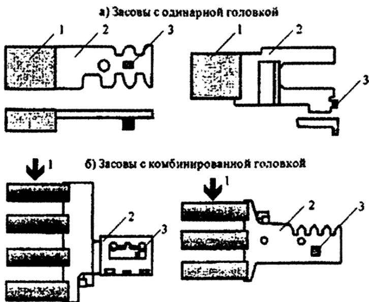
*Хвостовик засова* представляет собой пластину с конфигурацией, необходимой для перемещения засова при разблокировании механизма секретности с помощью ключа. Стойка хвостовика засова служит для удержания засова в фиксированных положениях. Она может устанавливаться как на хвостовике засова, так и на корпусе замка.
