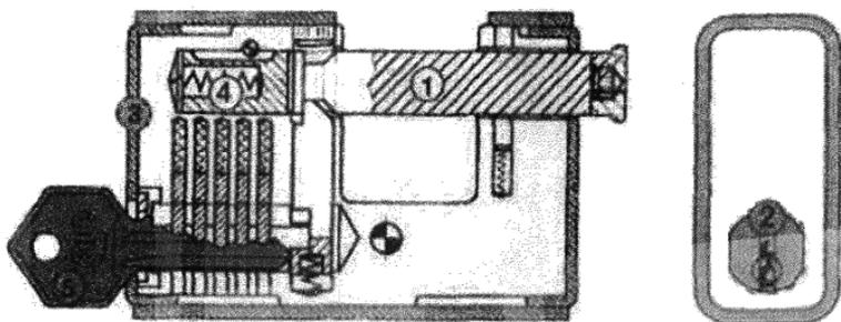
Условные обозначения: 1 — задвижка, 2 — цилиндрический механизм секретности, 3 — корпус, 4 — пружина, 5 — ключ.
