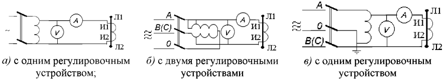
Рисунок П.1 – Схемы снятия характеристик намагничивания трансформаторов тока
