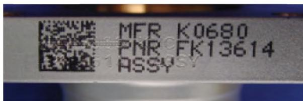
Рисунок 1 — Маркировка для визуального чтения, нанесенная в непосредственной близости к двумерному символу штрихового кода
