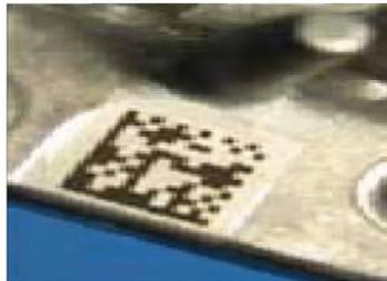
Рисунок А.6 — Электрохимическое травление металла
