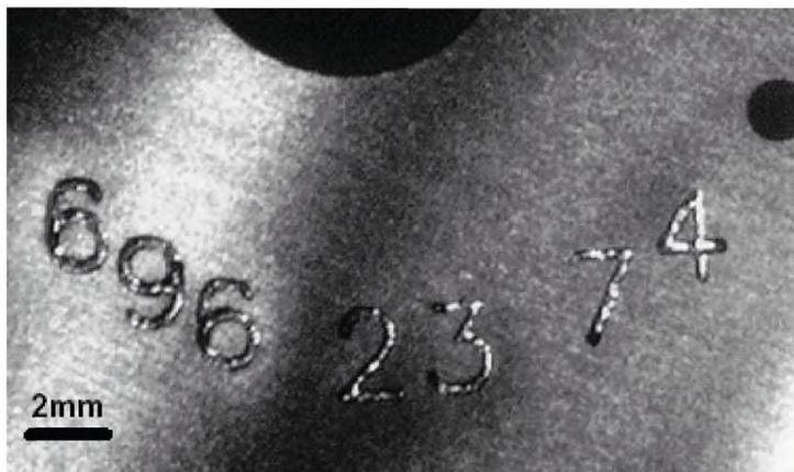
Рисунок В.7 — Выпуклая маркировка, нанесенная методом LENS
