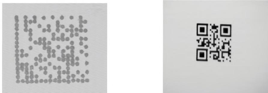
Рисунок В.2 — Маркирование методом каплеструйной печати
