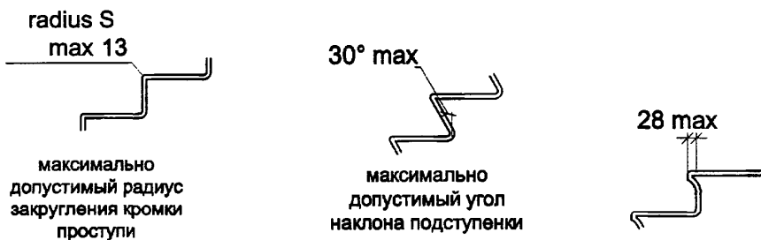
Рисунок 7.23 - Варианты сопряжения подступенки - проступи и габариты ступеней
