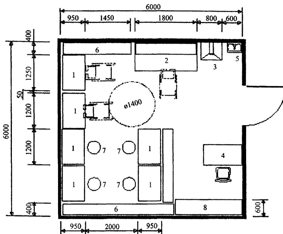
1 – стол монтажный; 2 – стенд испытательный; 3 – стол с вытяжкой; 4 – стол приемщика; 5 – мойка;
