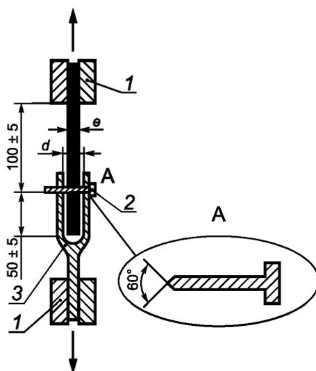
$e$  — толщина образца;  $d$  — расстояние между зубцами ( $e + 1 \leq d \leq e + 2$ ); 1 — зажимы разрывной машины; 2 — гвоздь диаметром  $(2,5 \pm 0,1)$  мм; 3 — захватное устройство
