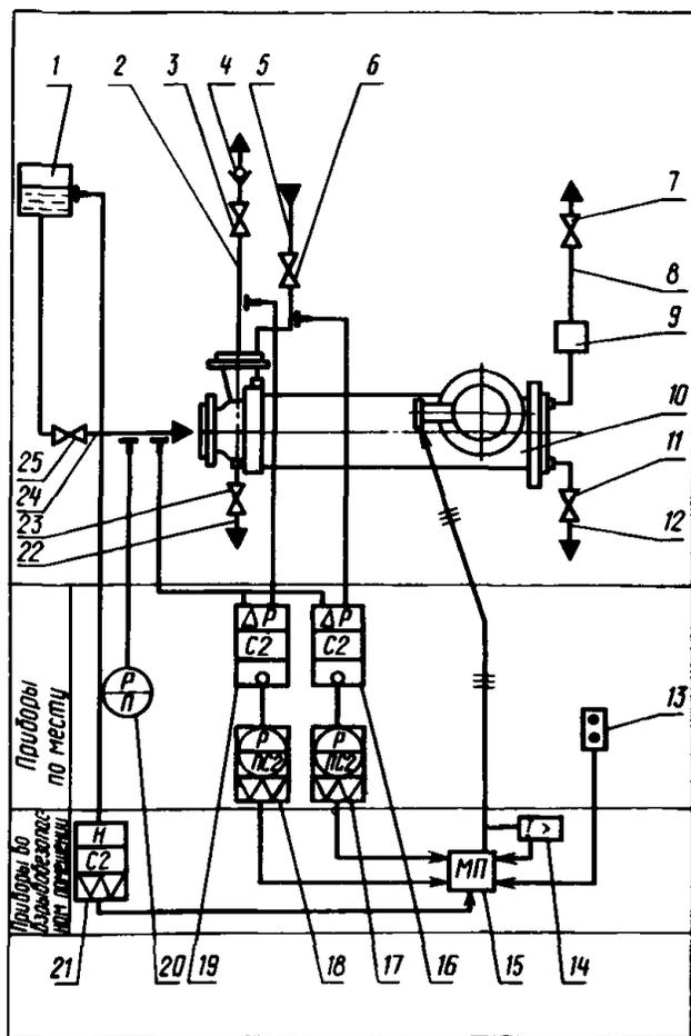
Общая схема автоматизации электронасосов:
