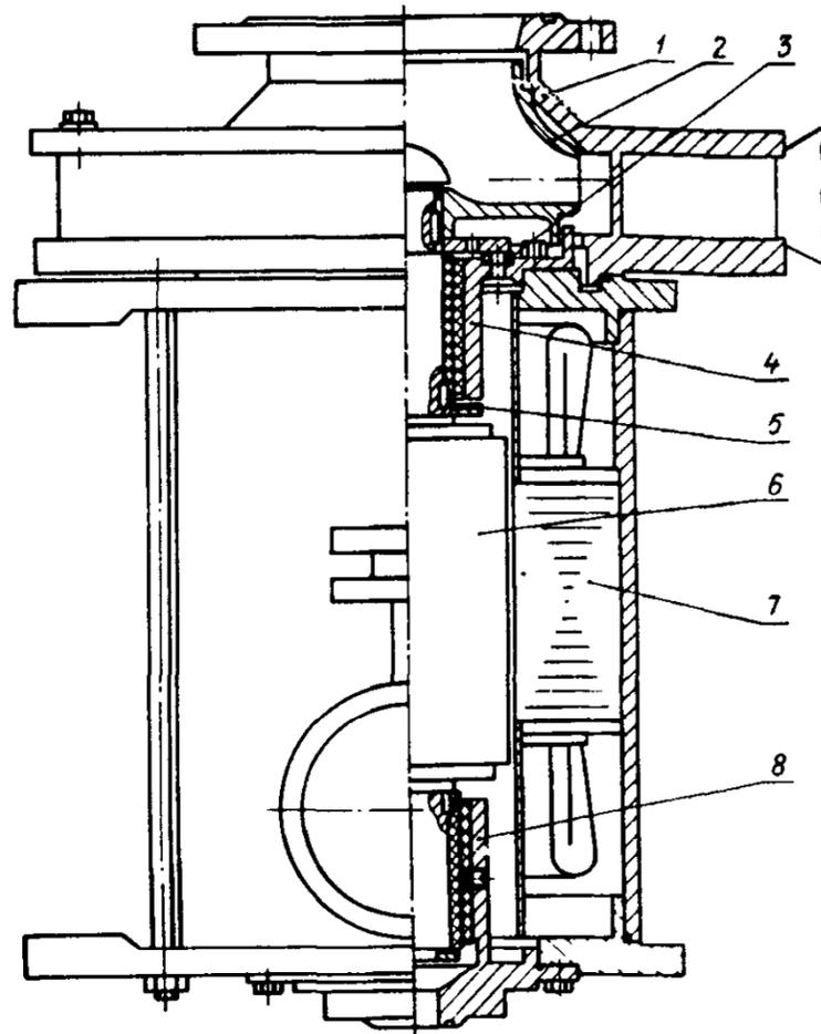
Разрез электронасоса типа 1БЭН:
