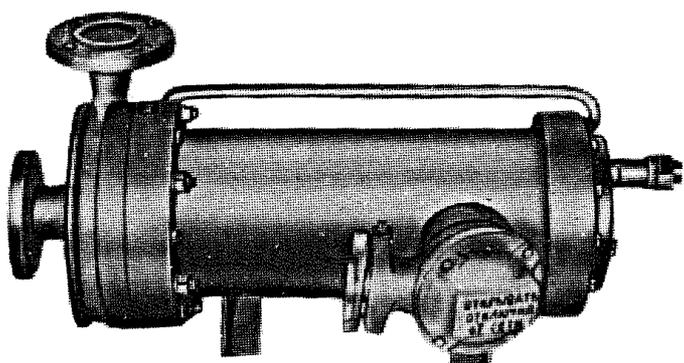
Предназначен для перекачивания в холодильных установках промышленных судов жидкого аммиака (ГОСТ 6221—75) температурой от  $-45$  до  $+25^{\circ}\text{C}$ , с примесью масла ХА-30 (ГОСТ 5546—66) не более 4% по объему, с наличием неабразивных включений массовой концентрацией не более 0,2%, размером частиц до 0,2 мм.
