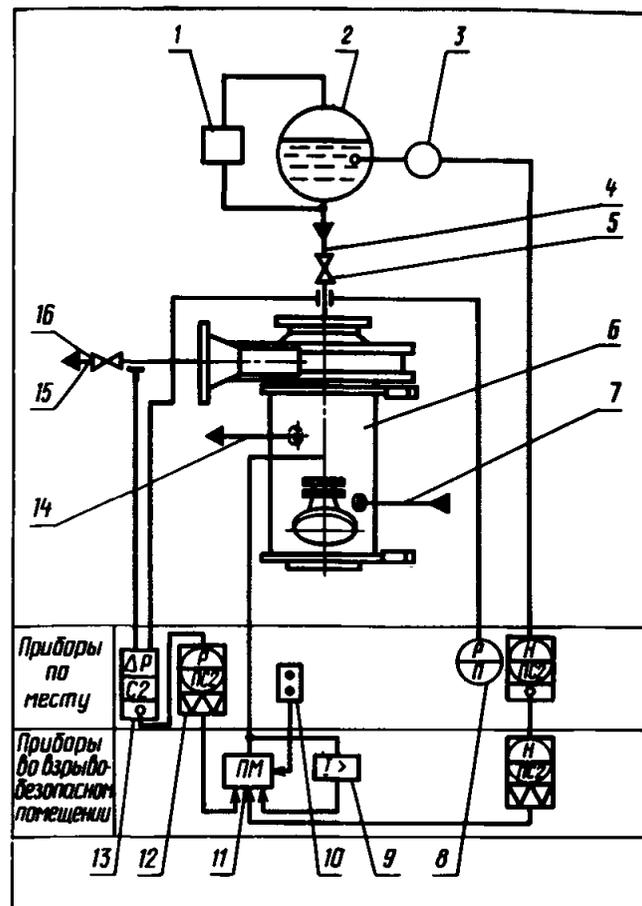
Общая схема автоматизации электронасосов типа БЭН:
