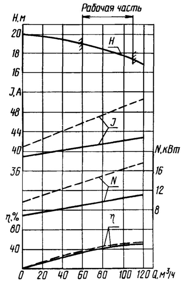
Характеристика электронасоса БЭН-10Ж (кривые, выполненные сплошной линией, — для жидкостей плотностью 1000 кг/м<sup>3</sup>, пунктирной — для жидкостей плотностью 1700 кг/м<sup>3</sup>)
