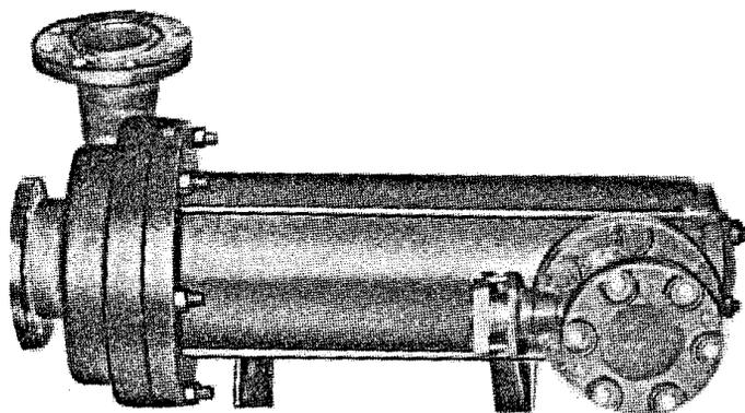
Предназначены для перекачивания в стационарных условиях агрессивных, токсичных и легковоспламеняющихся жидкостей температурой от  $-10$  до  $+50^{\circ}\text{C}$ , плотностью не более  $1100 \text{ кг/м}^3$ , массовой концентрацией твердых неабразивных включений до 20%, размером частиц не более 5 мм (из них 85% размером до 0,1 мм и 10% размером до 1 мм).
