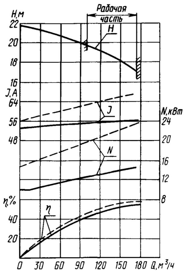
Характеристика электронасоса БЭН-9Ж (кривые, выполненные сплошной линией, — для жидкостей плотностью 1000 кг/м<sup>3</sup>, пунктирной — для жидкостей плотностью 1700 кг/м<sup>3</sup>)
