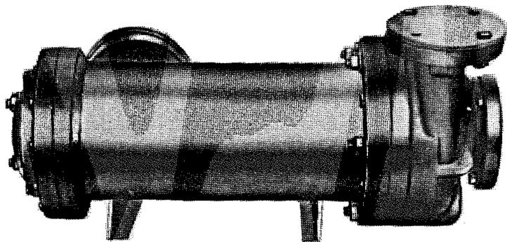
Предназначен для перекачивания в стационарных условиях агрессивных и легковоспламеняющихся жидкостей плотностью до  $1300 \text{ кг/м}^3$ , температурой от  $0$  до  $10^\circ\text{C}$ , содержащих твердые неабразивные включения массовой концентрацией до  $15\%$ , размером частиц не более  $0,1 \text{ мм}$ .
