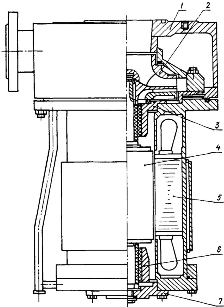
Разрез электронасоса типа БЭН-Ж:
