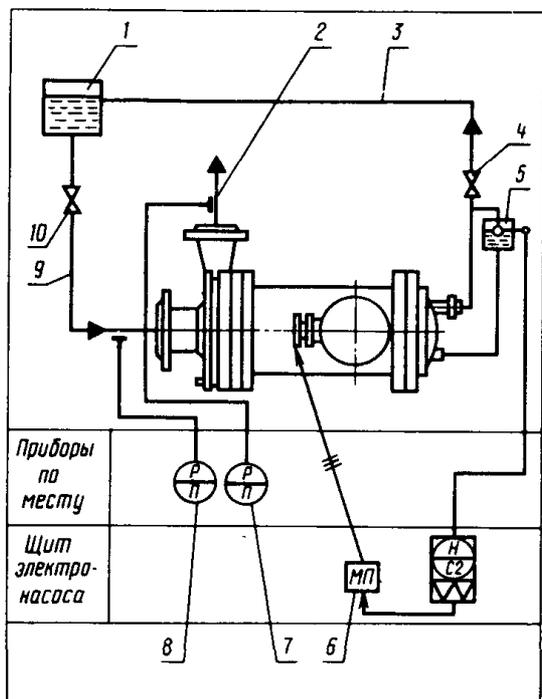
Общая схема автоматизации электронасоса БЭН-72:
