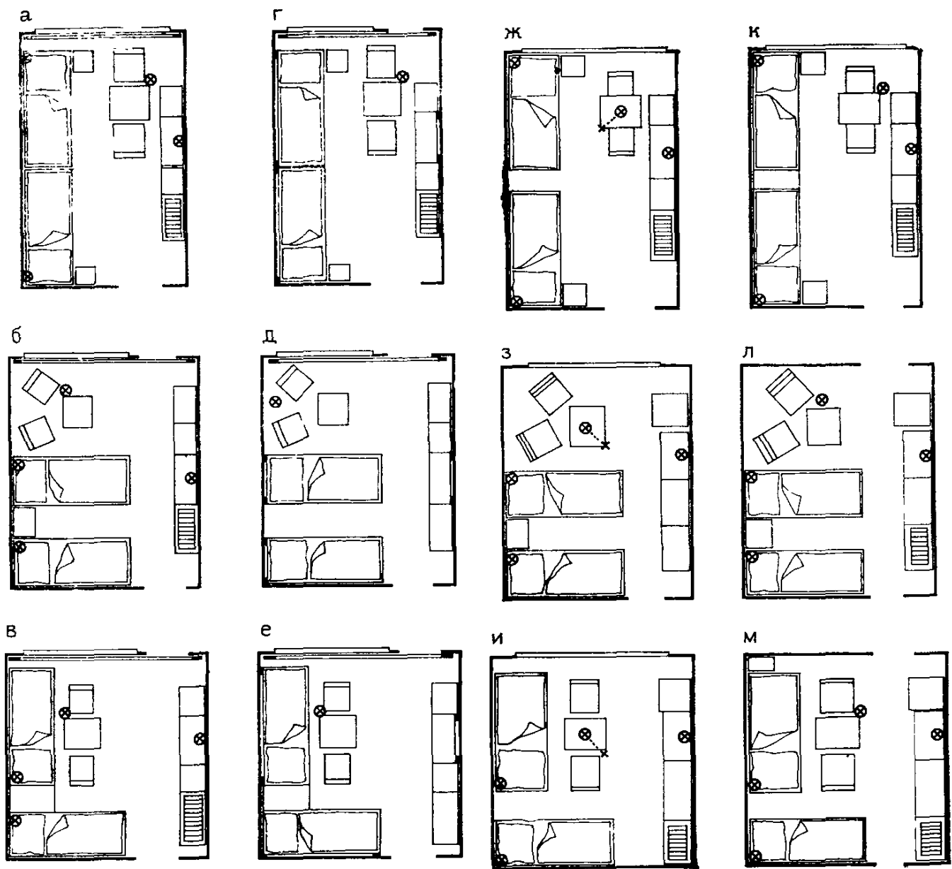
Рис. 46. Схемы решения искусственного освещения двухместных комнат в санаториях, домах отдыха, пансионатах и курортных гостиницах высшего, I и II разрядов
