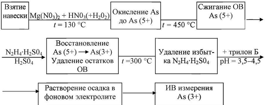
Рисунок 2 — Основные этапы подготовки проб пищевых продуктов и продовольственного сырья при проведении ИВ измерений для определения массовых концентраций мышьяка
