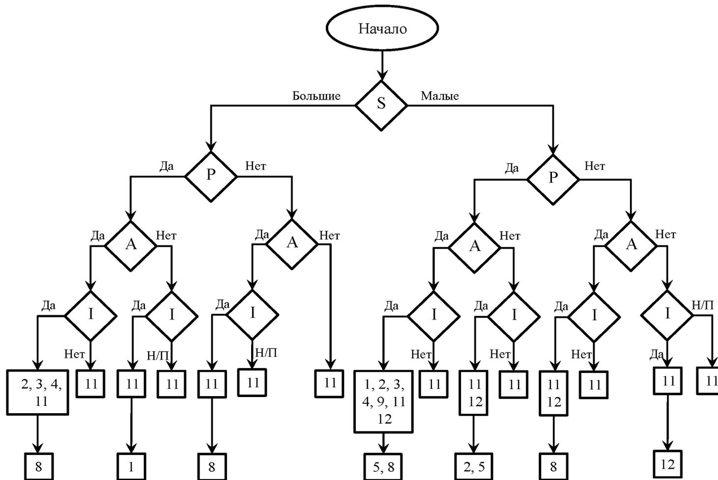
Рисунок А.1 – Дерево решений для выбора метода испытаний на герметичность (классификация и быстрые результаты)
