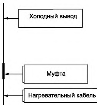
Рисунок 1 – Типовое расположение элементов при испытании муфты
