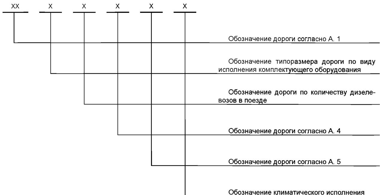
Пример условного обозначения и подземной подвесной монорельсовой дороги для применения во взрывоопасных средах с двумя подвесными дизелевозами мощностью по 68 кВт каждый, с перевозкой штучных грузов массой до 16 т, в климатическом исполнении Т: ПДВ-2х68-16-Т-ТУ...
