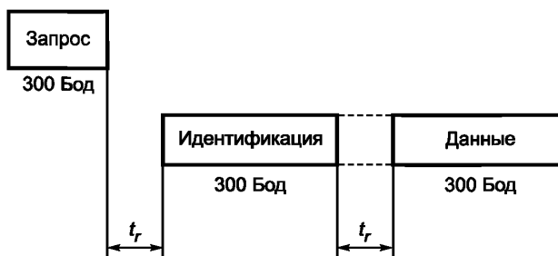
Протокол передачи для режима С, позволяющий считывание данных без подтверждения от ПСУ
