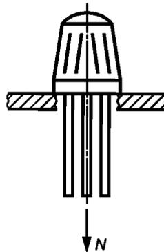
Рисунок 106 — Пример приложения усилия натяжения по оси зажима
