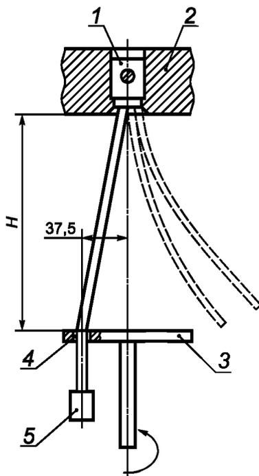
1 — зажим; 2 — фиксирующее устройство; 3 — диск на валу;
