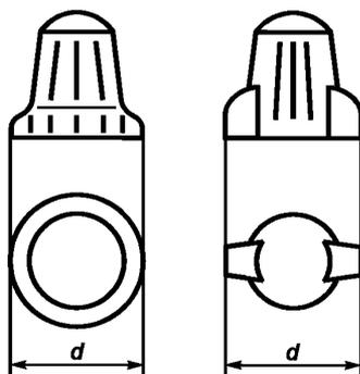
Рисунок 104 — Охватываемые размеры
